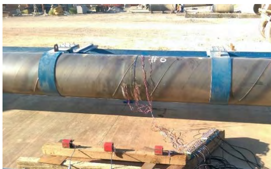
Εικόνα 3. 11: Μετρητικά συστήματα μετατοπίσεων (wires).
