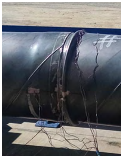
Εικόνα 3. 18: Μορφή αστοχίας πρώτου δοκιμίου ( D/t=191 , διπλή συγκόλληση).
