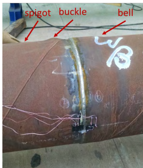
Εικόνα 3. 37: Μορφή αστοχίας έκτου δοκιμίου ( D/t=103 , μονή εξωτερική συγκόλληση).
