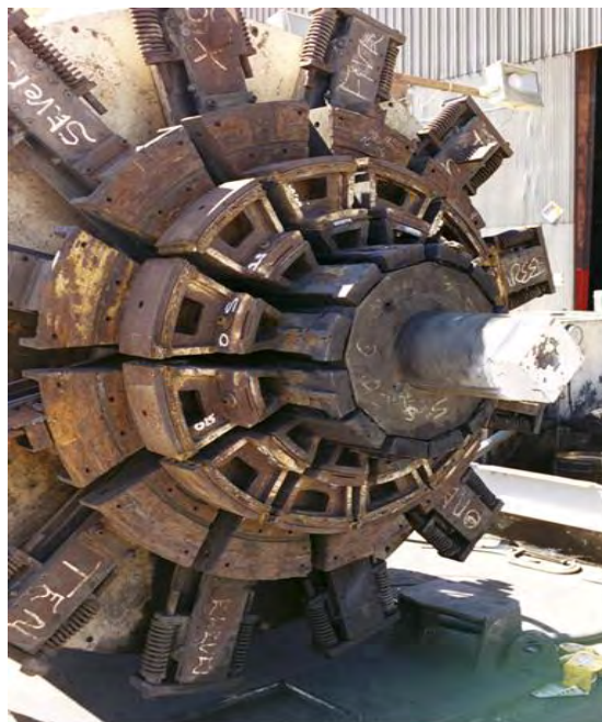
Εικόνα 2. 3: Υδραυλικός διευρυντής (hydraulic expander),(Mason 2006).
