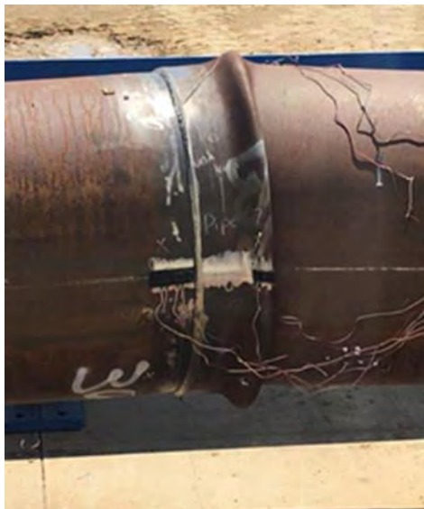
Εικόνα 3. 29: Μορφή αστοχίας εβδόμου δοκιμίου ( D/t=103 , διπλή συγκόλληση).
