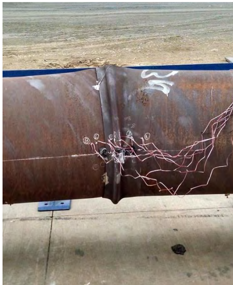
Εικόνα 3. 33: Μορφή αστοχίας πέμπτου δοκιμίου ( D/t=103 , μονή εσωτερική συγκόλληση).
