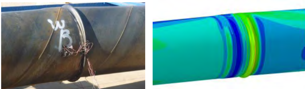
Εικόνα 4. 15: Μορφή αστοχίας ( D/t = 191 , μονή εξωτερική συγκόλληση).
