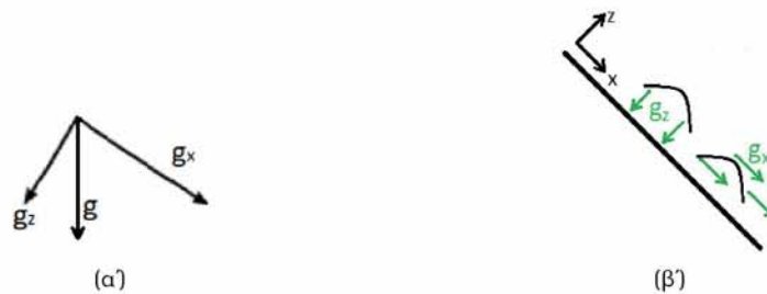
Σχήμα 9.5: (α) Οι συνιστώσες της επιταχύνσεως της βαρύτητας & (β) οι επιδράσεις τους σε μια διαταραχή
