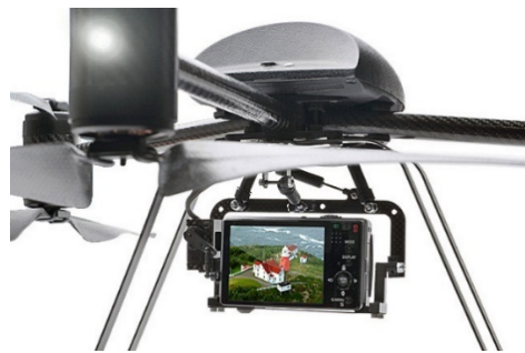
Εικόνα 12 – Ενσωματωμένη ψηφιακή κάμερα στο UAV
