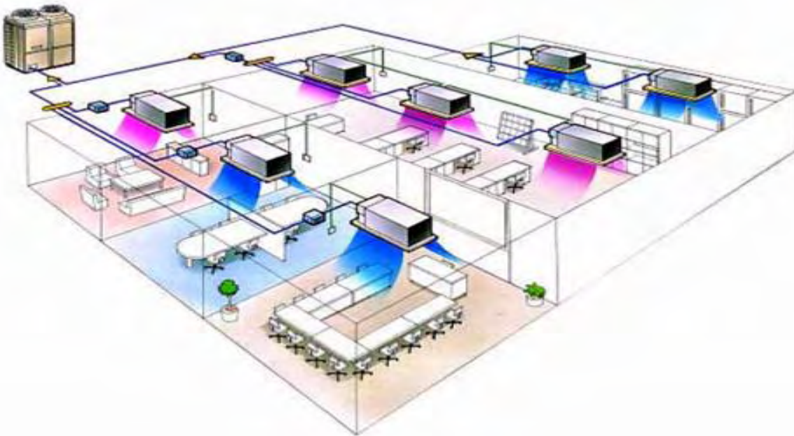
ΣΧΗΜΑ 12: Σχηματική απεικόνιση συστήματος VRV
