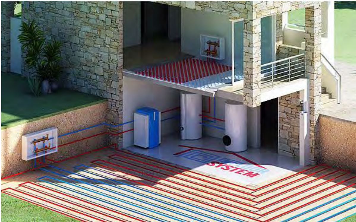
ΣΧΗΜΑ 17: Γεωθερμία κλειστού τύπου με οριζόντιο γεωεναλλάκτη
