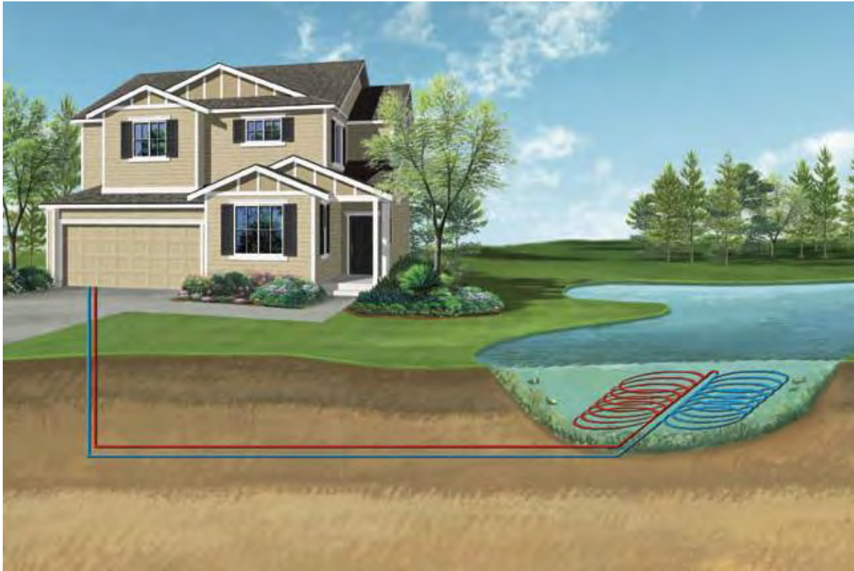
ΣΧΗΜΑ 20: Γεωθερμία κλειστού τύπου με καταβυθιζόμενο γεωεναλλάκτη
