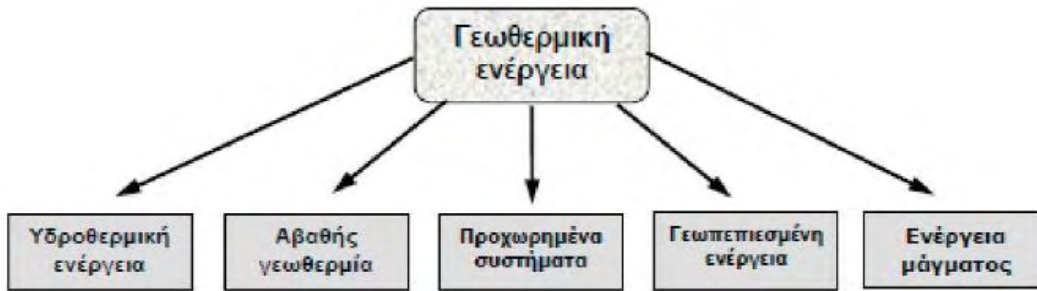
ΣΧΗΜΑ 15: Μορφές γεωθερμικής ενέργειας κατά σειρά ενδιαφέροντος χρήσεως σήμερα και προοπτικής στο εγγύς μέλλον, από αριστερά προς τα δεξιά
