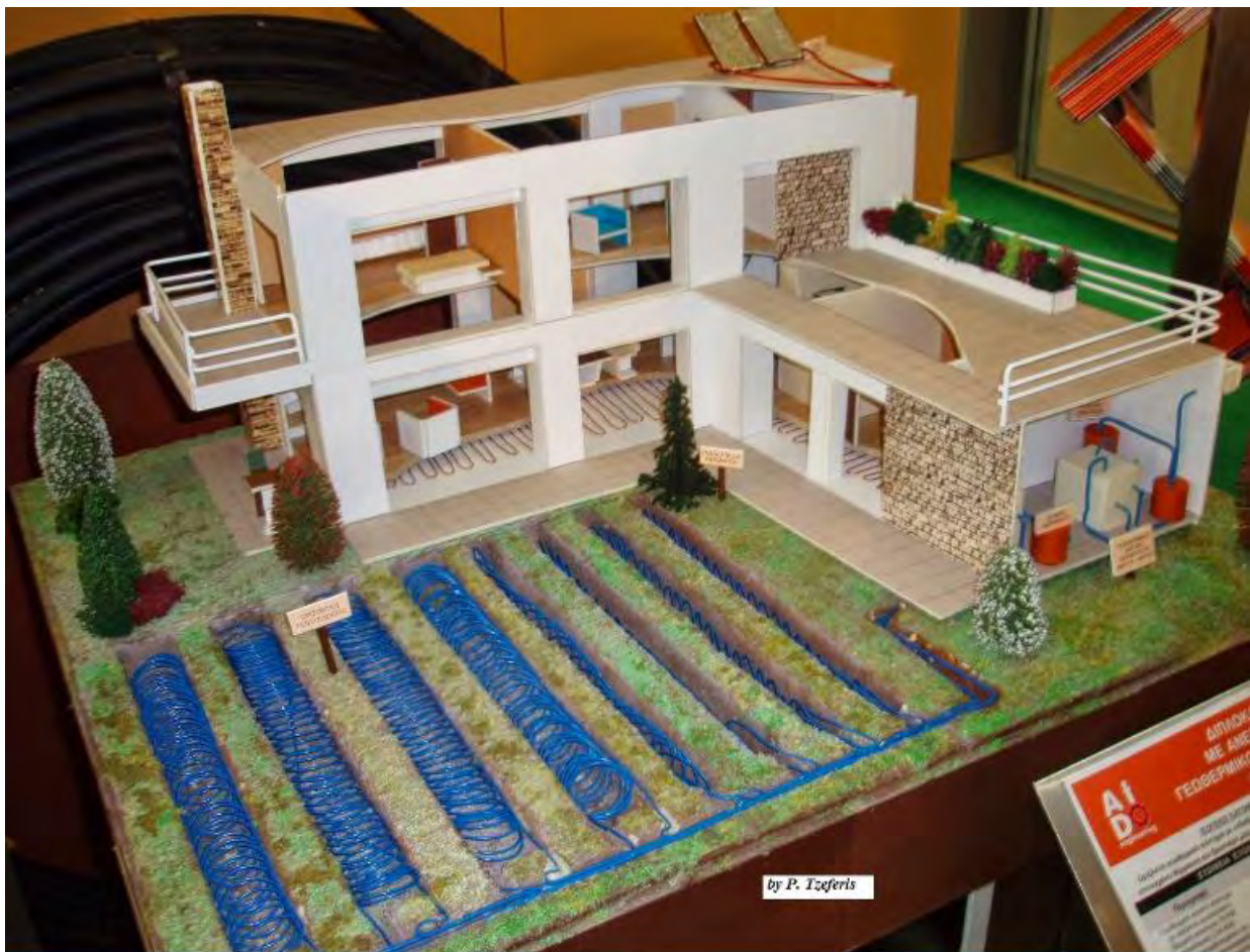
ΣΧΗΜΑ 18: Γεωθερμία κλειστού τύπου με σπειροειδή γεωεναλλάκτη
