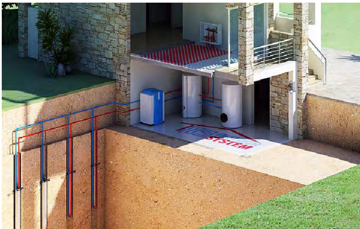
ΣΧΗΜΑ 19: Γεωθερμία κλειστού τύπου με κάθετο γεωεναλλάκτη
