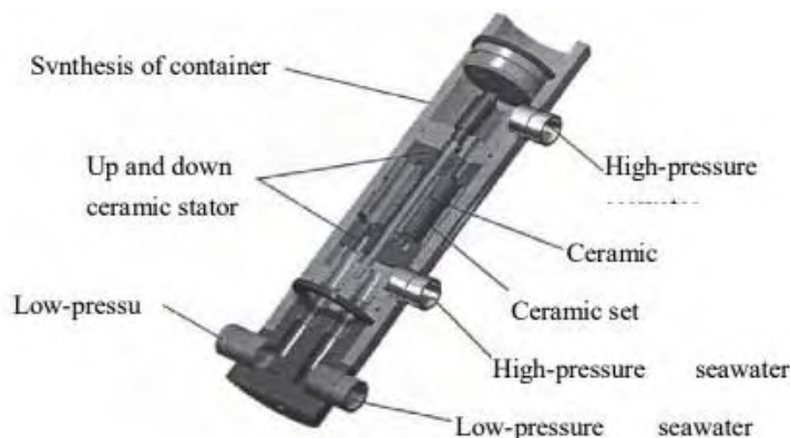
Σχήμα 2.10: Περιγραφή της εσωτερικής δομής του εναλλάκτη πίεσης (PX)[10]
