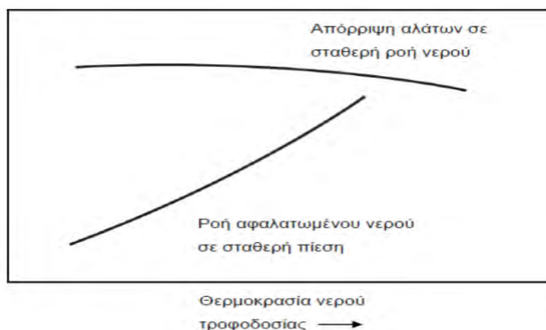
Σχήμα 4.9: Η επίδραση της θερμοκρασίας του νερού τροφοδοσίας στη ροή του αφαλατωμένου νερού και στην απόρριψη αλάτων
