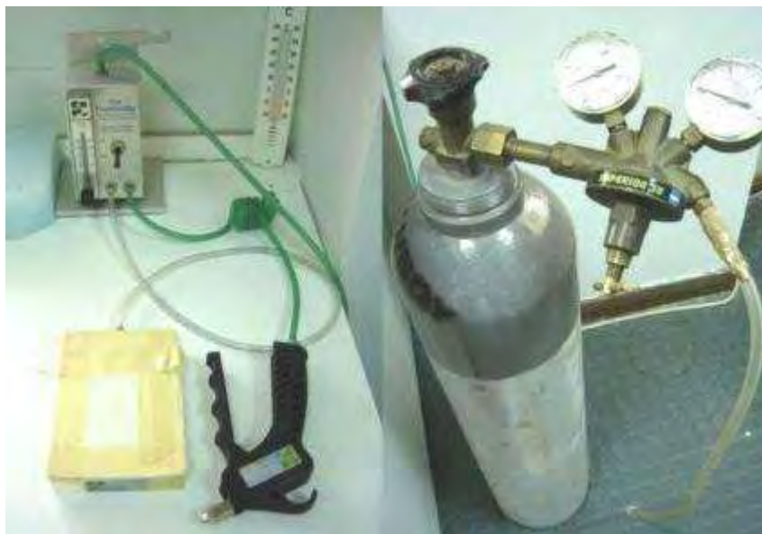
Εικόνα 5 Σύστημα για την αναισθητοποίηση της μύγας της Μεσογείου με τη χρήση CO 2
