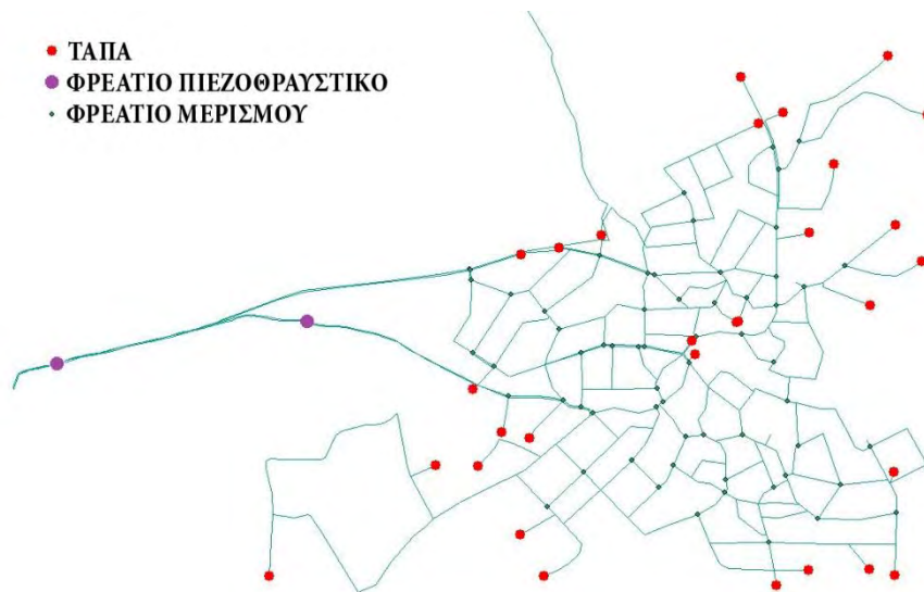
Εικόνα 11: Δίκτυο Αιανής σε μορφή CAD (χρήση προγράμματος Epanet)
