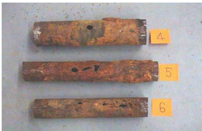
Εικόνα 3: Διαβρωμένοι χαλύβδινοι αγωγοί (Greyvenstein and Van Zyl, 2006)
