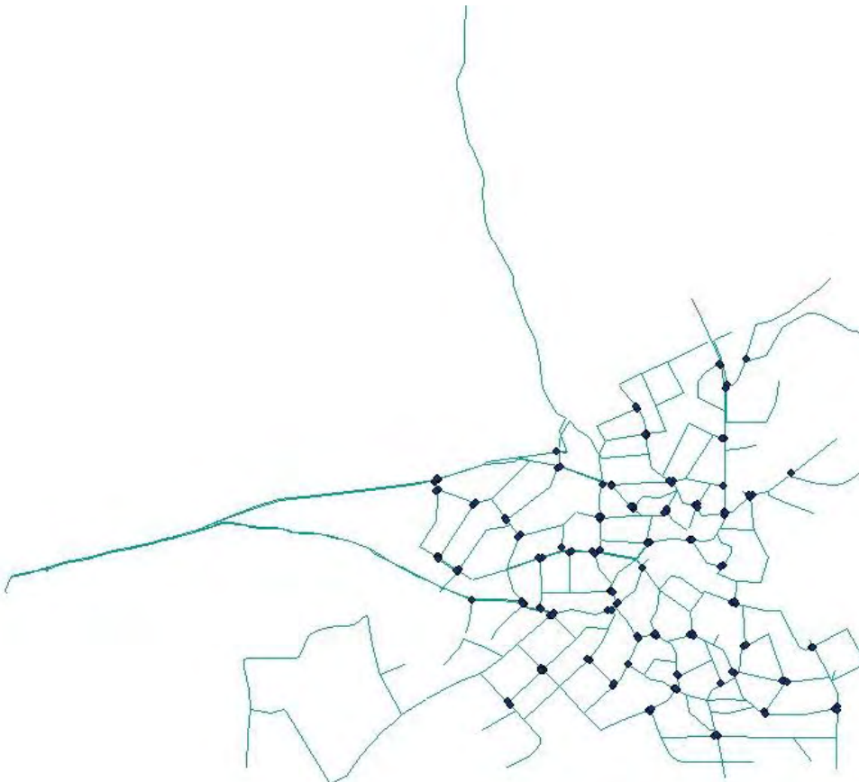
Εικόνα 13: Αποτύπωση θέσης βαλβίδων σε μορφή CAD (χρήση προγράμματος Arc Gis)
