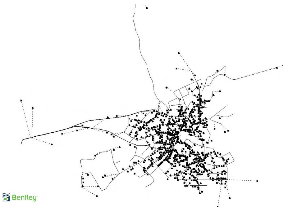
Εικόνα 32: Τελική μορφή μοντέλου δικτύου σε περιβάλλον WaterGems
