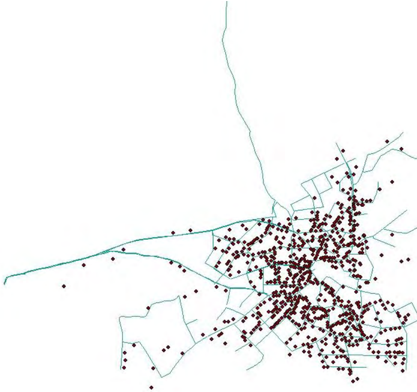
Εικόνα 12: Αποτύπωση θέσης μετρητών κατανάλωσης σε μορφή CAD (χρήση προγράμματος Arc Gis)
