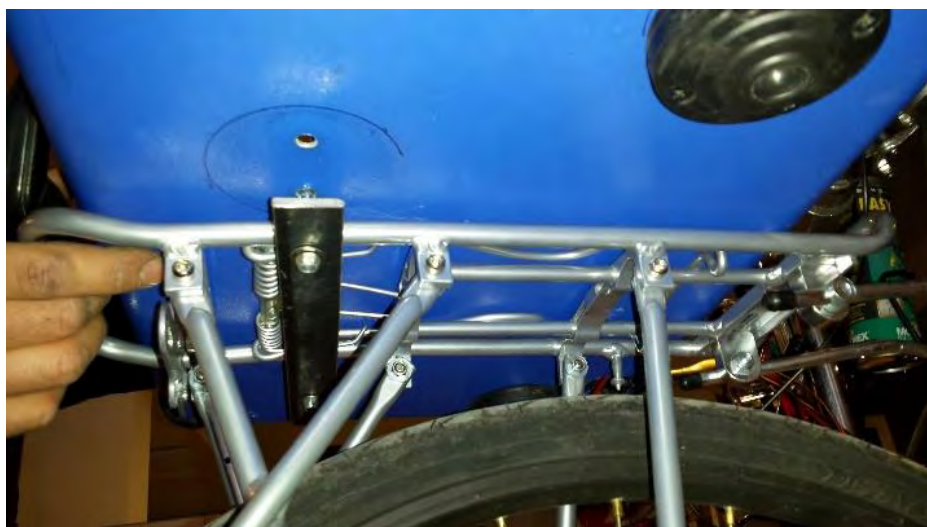
Εικόνα 3.7 στερεοποίηση οπίσθιας σχάρας
