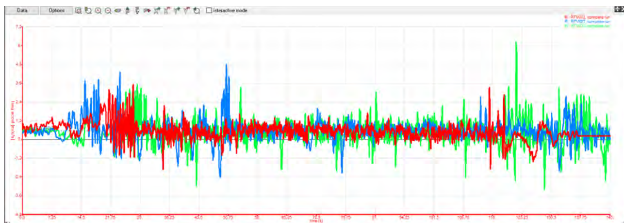
Διάγραμμα 4.48: Διάγραμμα διαμήκους επιτάχυνσης πηγή : (race technology)
