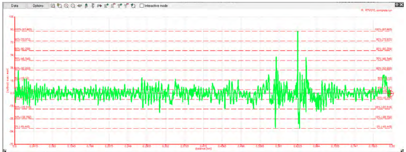
Διάγραμμα 4.42: Διάγραμμα ρυθμού εκτροπής πηγή : (race technology)
