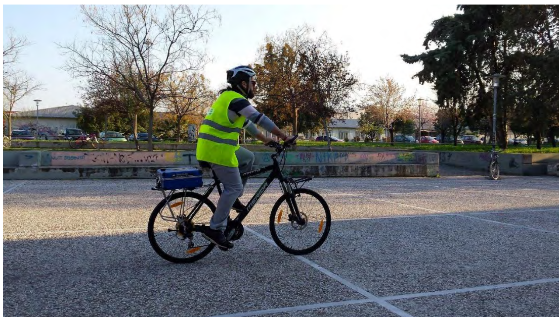
Εικόνα 3.8: διαδικασία βαθμονόμησης εξοπλισμού με αναβάτη με ενδεδειγμένη εξάρτηση
