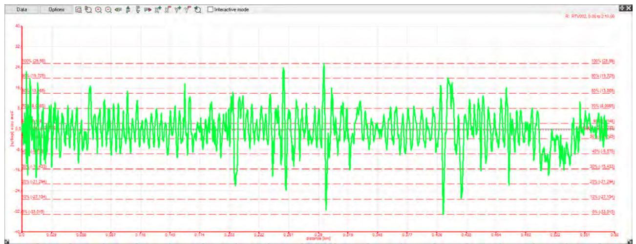
Διάγραμμα 4.7: Διάγραμμα ρυθμού εκτροπής πηγή : (race technology)
