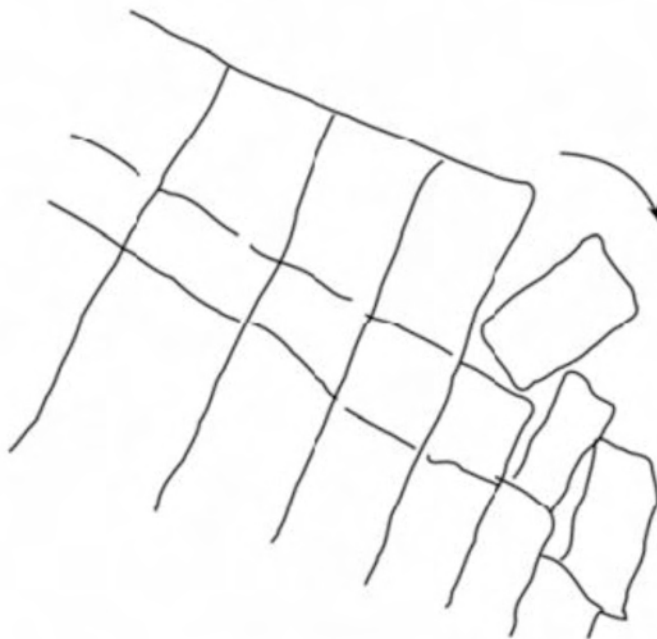
Εικόνα 2.4: Σχηματική απεικόνιση ανατροπής [12]
