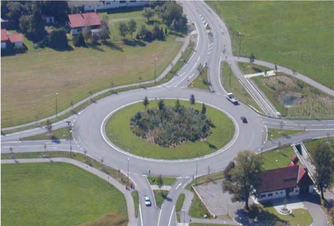
Σχήμα 3.8 Παράδειγμα («μικρού») υπεραστικού κυκλικού κόμβου δύο λωρίδων στη Γερμανία. Αποκλειστικά μία λωρίδα εξόδου και απουσία διαγράμμισης στον κυκλικό δακτύλιο (Brilon, 2011)
