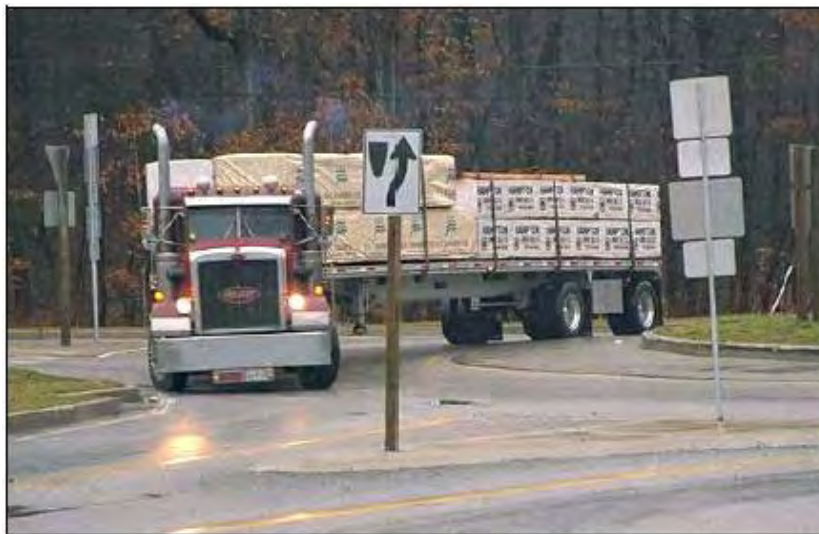
Σχήμα 3.6 Κόμβος με ποδιά (truck apron) για την εξυπηρέτηση μεγάλων φορτηγών οχημάτων (NCHRP, 2010)
