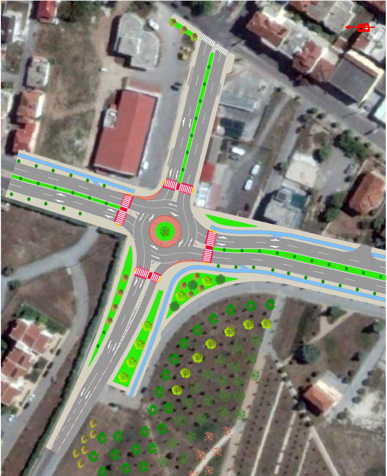
Σχήμα 8.9 Οριζοντιογραφική αποτύπωση του προτεινόμενου Κ 3 στη διασταύρωση των οδών Σαρίμβη και Ι. Λάτσιου
