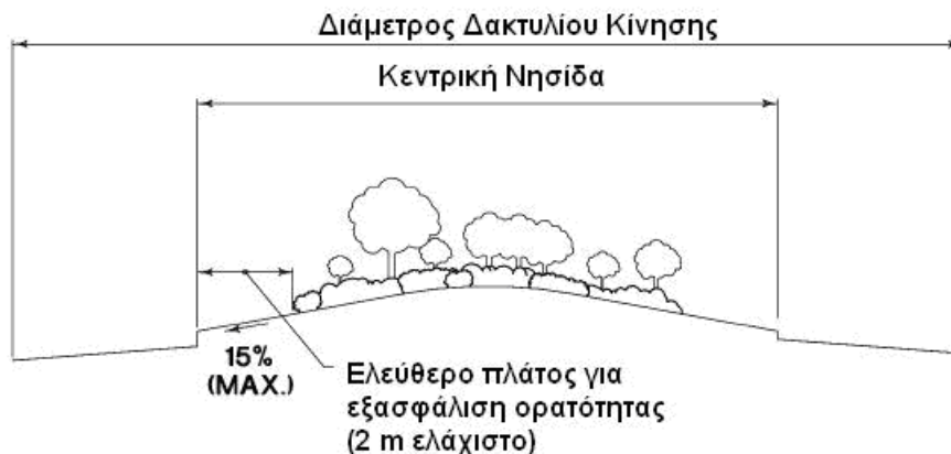
Σχήμα 5.7 Τυπική τοπιοτεχνία κεντρικής νησίδας με πρόβλεψη για ορατότητα (ΟΜΟΕ Κ 3 , 2011)
