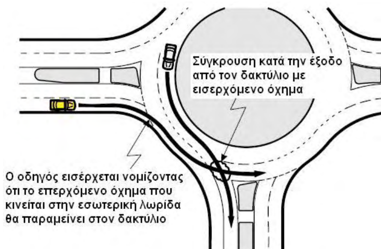
Σχήμα 7.2 Συγκρούσεις κατά την έξοδο λόγω λάθους στην επιλογή λωρίδας του κινούμενου επί του δακτυλίου (ΟΜΟΕ Κ 3 , 2011)
