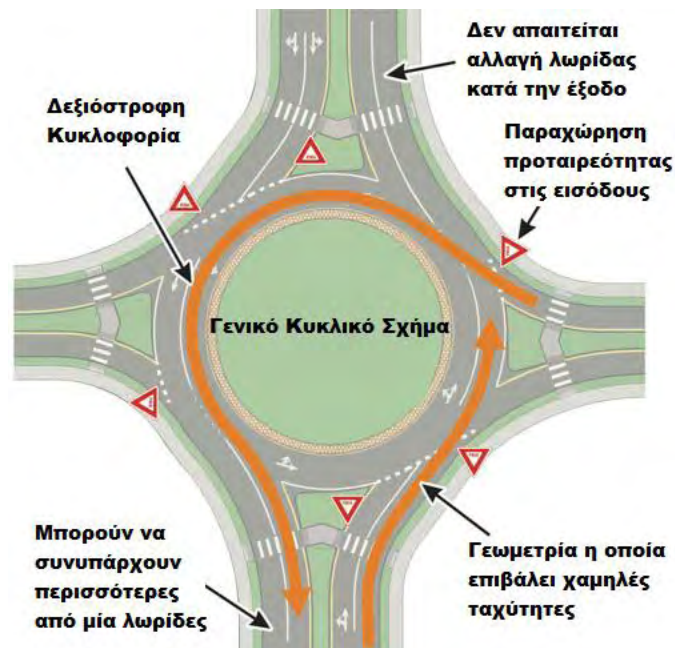
Σχήμα 2.4 Κύρια χαρακτηριστικά σύγχρονου Κόμβου Κυκλικής Κίνησης (NCHRP, 2010, ίδια επεξεργασία).
