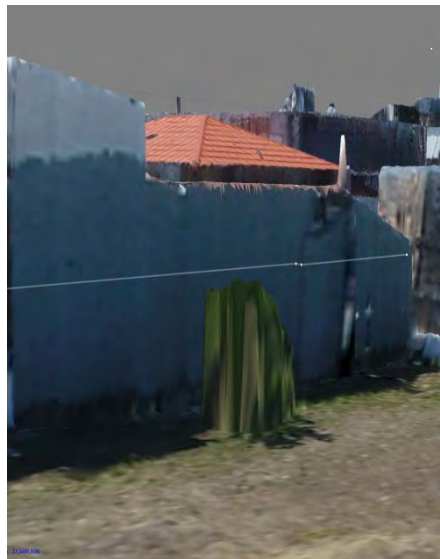
Εικόνα 5.16: Αδυναμία αναδόμησης σημείου λεπτομέρειας (δόντι επί της πλευράς του κτηρίου 0,15μ).
