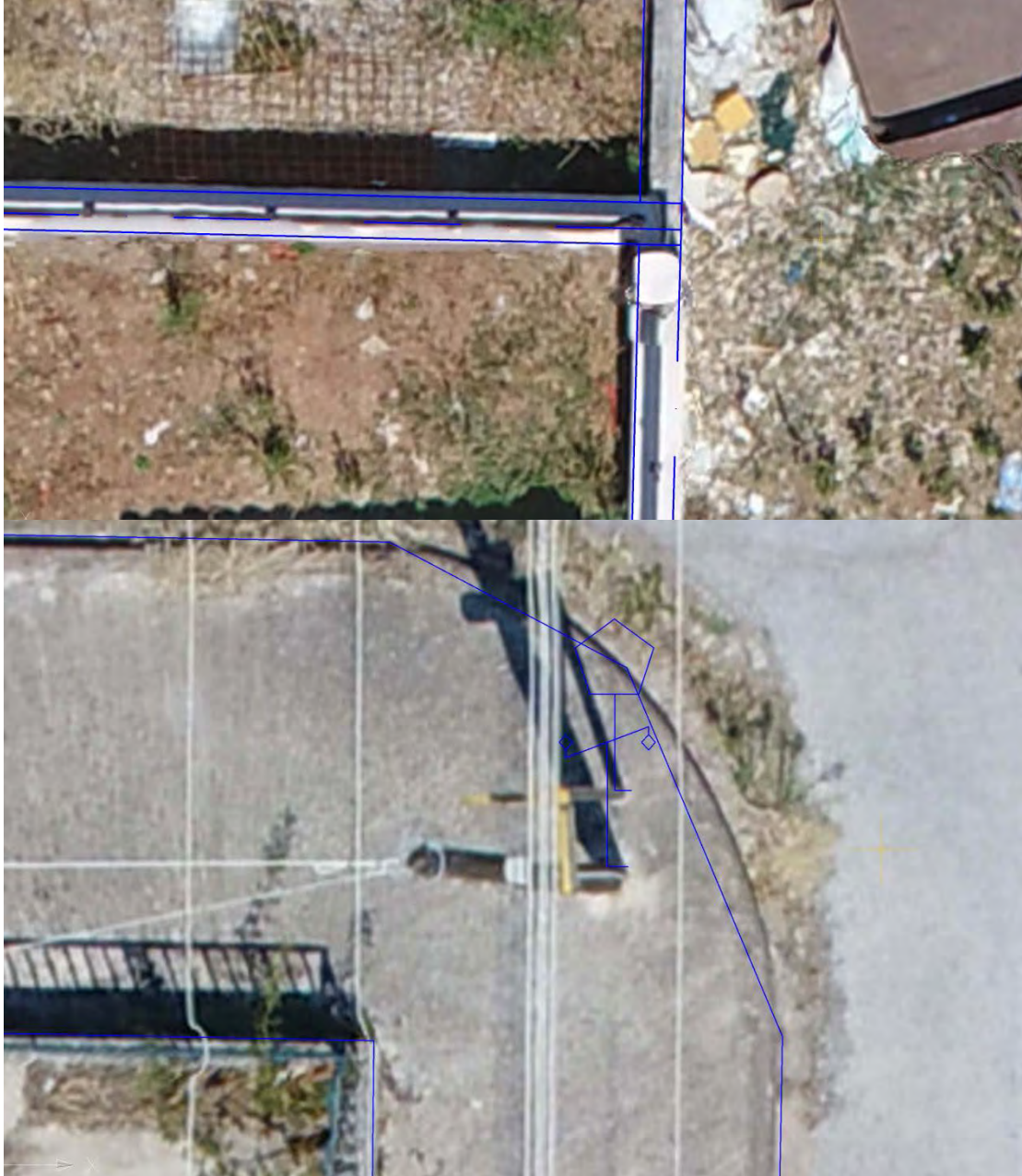
Εικόνα 5.18: Σύγκριση στοιχείων τοπογραφικής αποτύπωσης (μπλε χρώμα) με παραγόμενο ορθοφωτοχάρτη (υπόβαθρο). Πηγή: Ίδια Επεξεργασία
