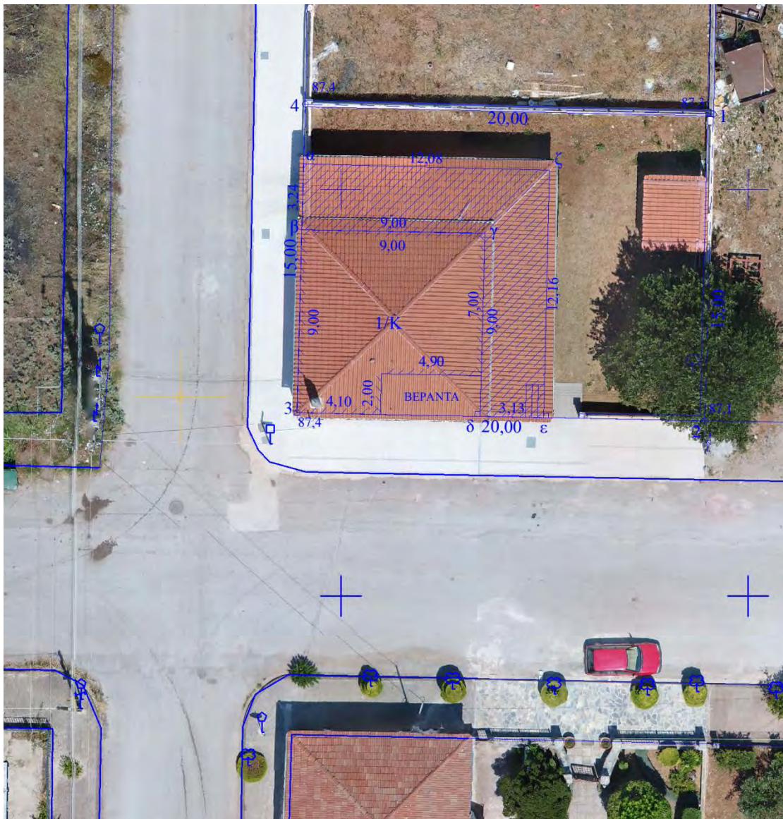
Εικόνα 5.17: Επίθεση παραγόμενου ορθοφωτοχάρτη σε στοιχεία υφιστάμενου τοπογραφικού διαγράμματος. Πηγή: Ίδια Επεξεργασία
