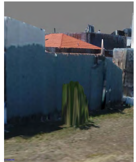
Εικόνα 5.16: Αδυναμία αναδόμησης σημείου λεπτομέρειας (δόντι επί της πλευράς του κτηρίου 0,15μ).
