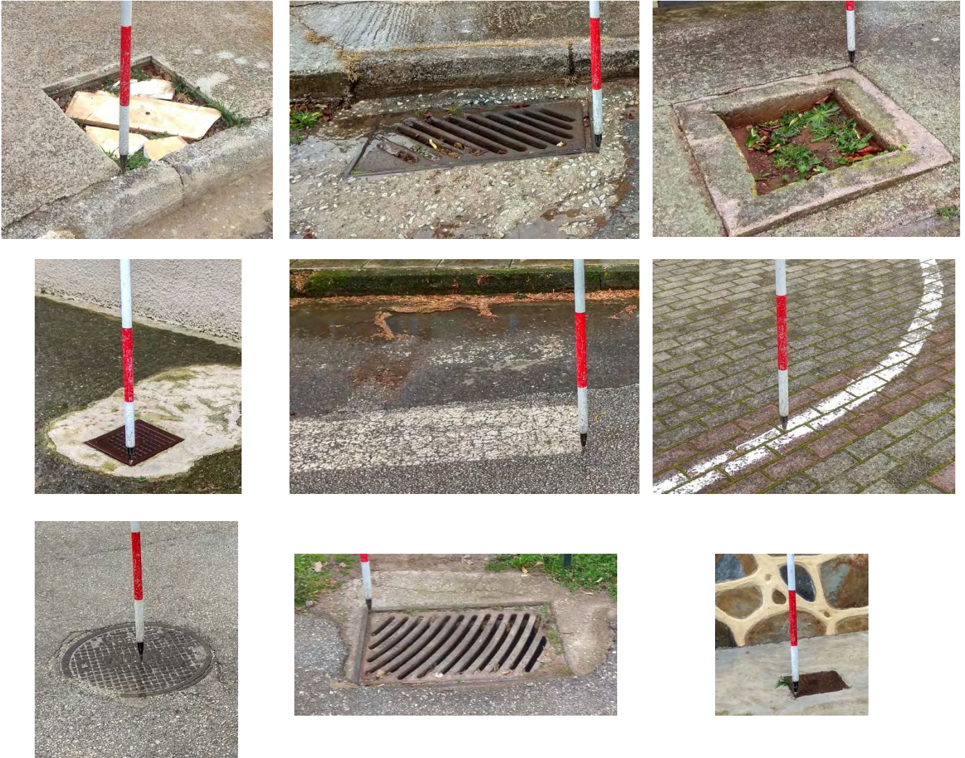
Εικόνα 5.7: Φωτοσταθερά και σημεία ελέγχου Πηγή: Ζούπης Δημήτρης (φωτογραφικό αρχείο)
