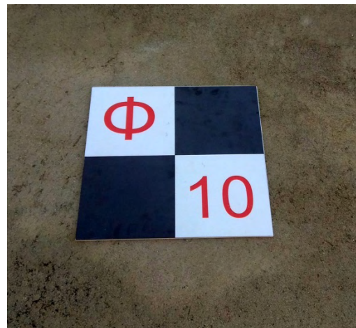
Εικόνα 5.6: Παράδειγμα Φωτοσταθερού Σημείου
