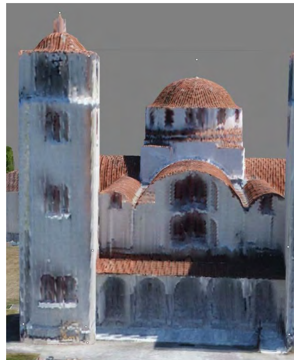
Εικόνα 5.14: 3D Point Cloud (αριστερά) – Απόδοση Υφής/Texture (δεξιά). Εμφανής η μη απόδοση του σταυρού στον τρούλο του Ιερού Ναού. Πηγή: Ίδια επεξεργασία
