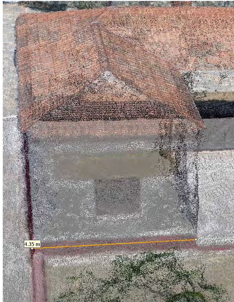
Εικόνα 5.15: Επαλήθευση μήκους πλευράς κτηρίου ομόρου Ιερού Ναού. Πηγή: Ίδια επεξεργασία
