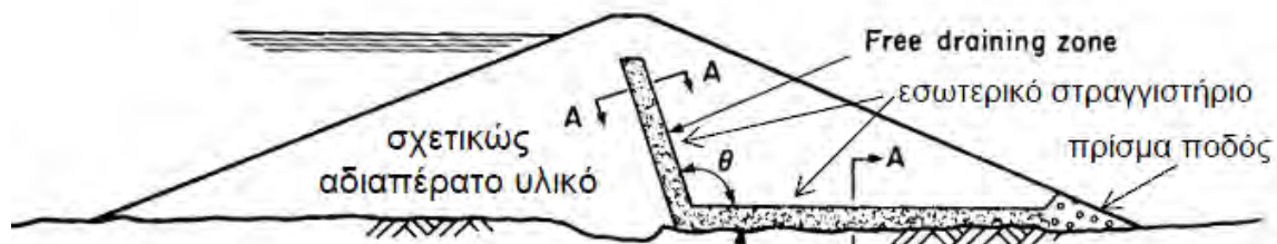
Εικόνα 2.3 Πλήρως ομοιογενές χωμάτινο φράγμα με κεκλιμένο στραγγιστήριο [8].
