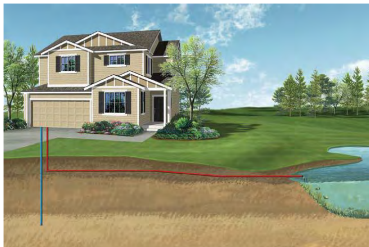
Σχήμα 13: Μεικτό σύστημα αβαθούς γεωθερμίας για θέρμανση κατοικίας
