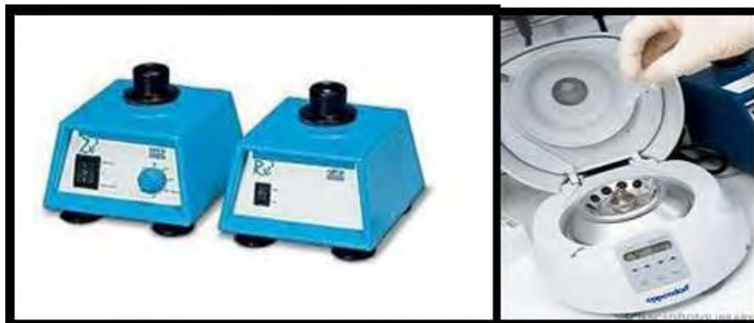
Εικόνα 24: Συσκευές ανάδευσης vortex και στροβιλισμού spin.
