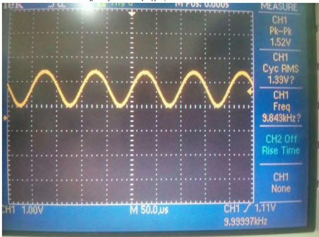
Εικόνα 5.17 Σήμα εξόδου παλμογράφου στα 10kHz και 20mV είσοδο
