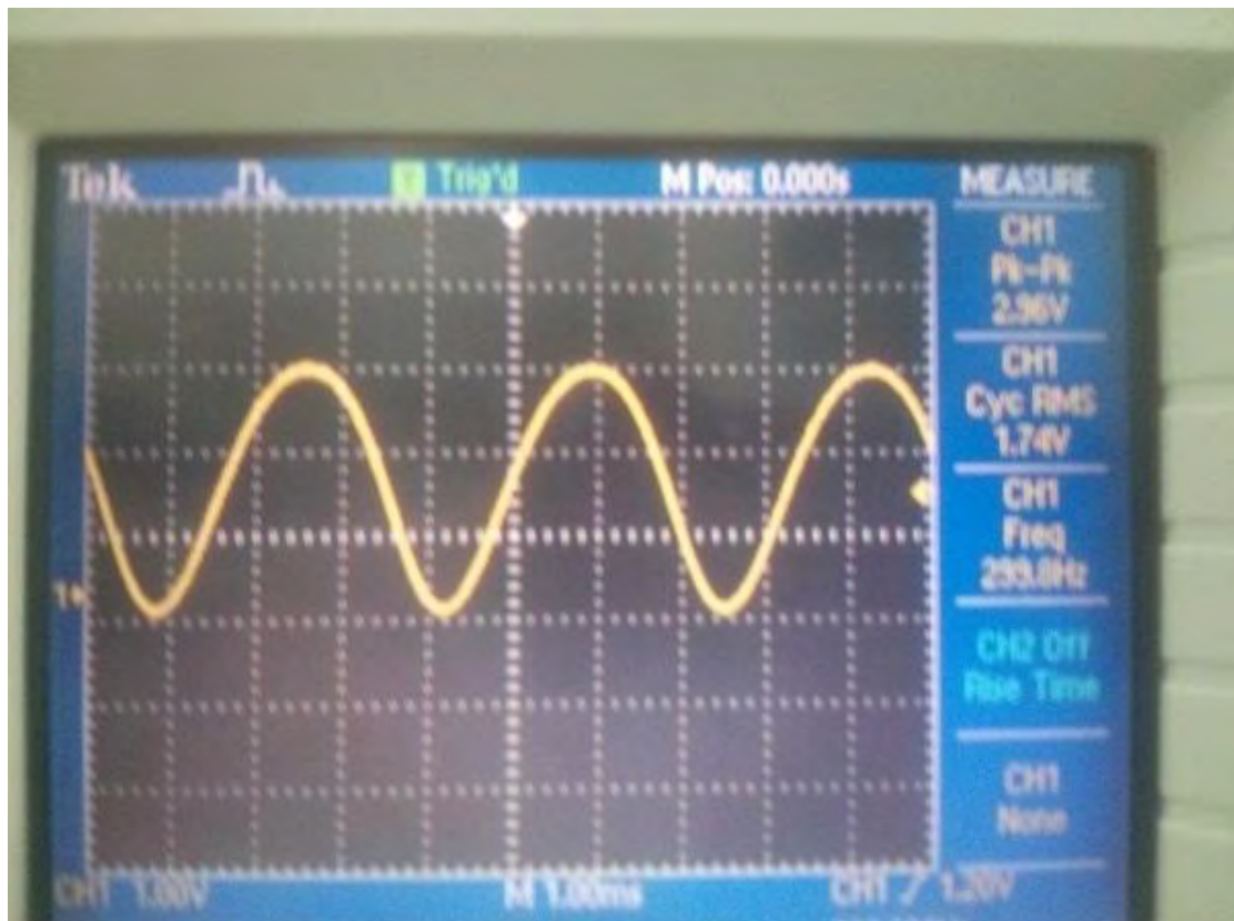
Εικόνα 5.4 Σήμα εξόδου παλμογράφου στα 300Hz και 20mV είσοδο
