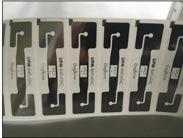
Εικόνα 7.2 - Οι παθητικές ετικέτες RFID που χρησιμοποιήθηκαν (RFID passive tag)
