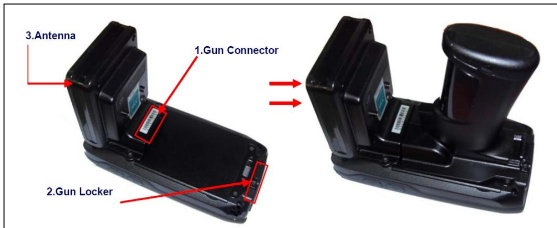
Εικόνα 7.1 – Ο αναγνώστης RFID που χρησιμοποιήθηκε (RFID Reader Gun-Type)
