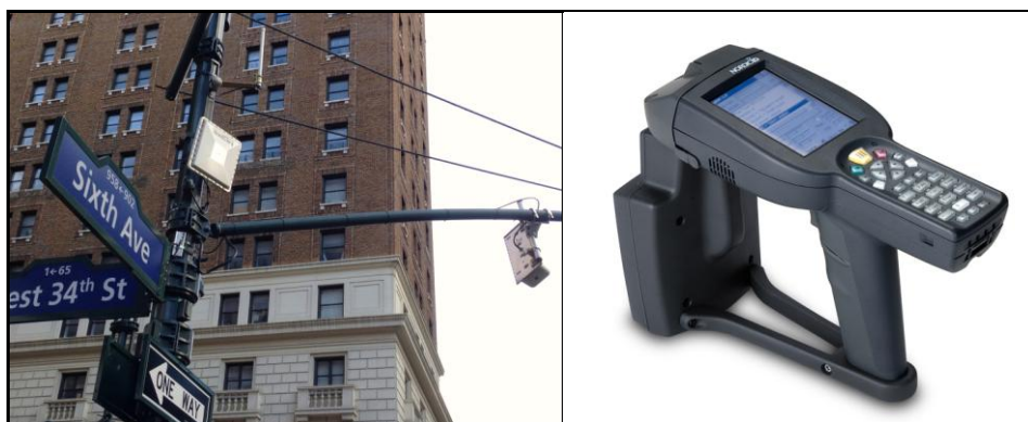
Εικόνα 3.3 - Σταθερός RFID Reader και κεραία(αριστερά), RFID Reader χειρός (δεξιά)
