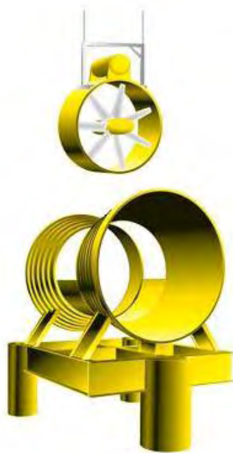
Εικόνα 6.12: Αποσυναρμολόγηση του δρομέα του στροβίλου. Πηγή: http://www.lunarenergy.co.uk/img/atkins-initial-tubular-desi.jpg
