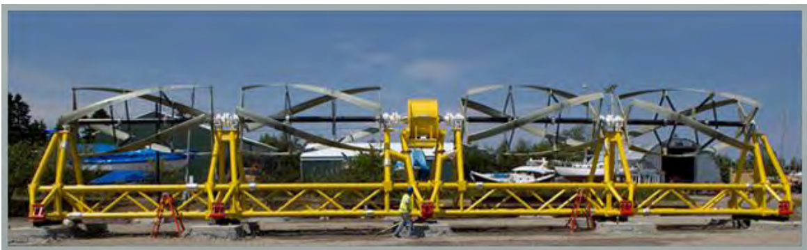
Εικόνα 6.5: Ο παλιρροϊκός υδροστρόβιλος TidGen. Πηγή: http://www.orpc.co/newsevents_photogalleryDetails.aspx?Aid=7vWHuJea%2BLw%3D
