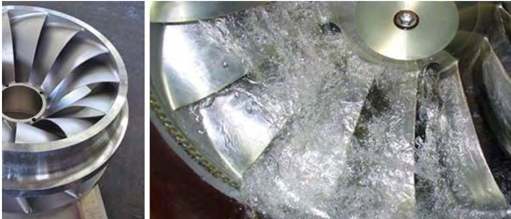
Εικόνα 4.14: Εκτεταμένη διάβρωση στα πτερύγια στροβιλομηχανής, η οποία προκλήθηκε από το φαινόμενο της σπηλαιώσης. Πηγή: http://www.steelfuture.com/de/images/lofthumbs/702x300/images/stories/generatori-di-potenza/turbina-francis.jpg
