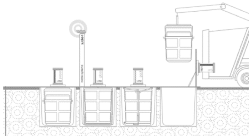
Σύστημα υπόγειων κάδων απορριμμάτων και ανακύκλωσης, πηγή: http://www.ecosynergy.gr/details2.php?lang=1&wh=1&the1id=9&the2id=33&theid=33&open1=9&open2=33&theid=144&page=1
