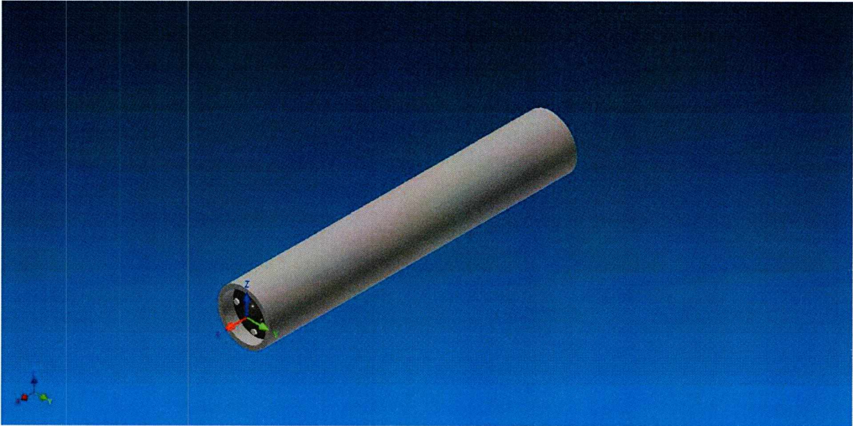
Σχήμα 3.4: Μεγάλη κοιλότητα για την θερμενόμενη σφαιρική επιφάνεια Y = -25 \text{ mm}
