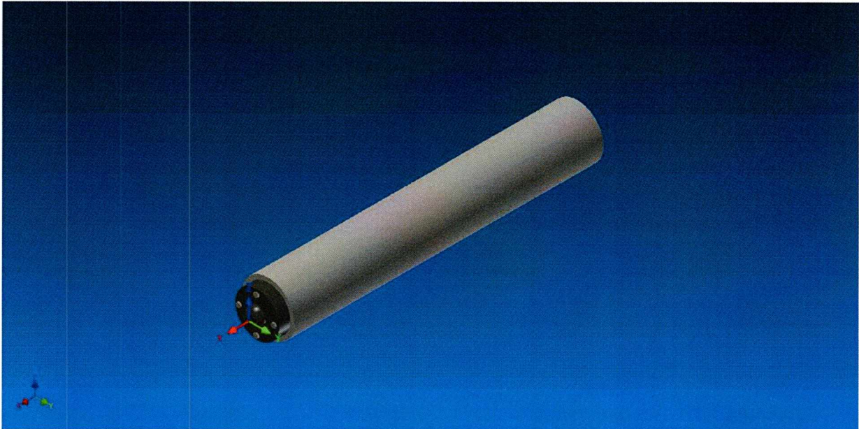
Σχήμα 3.6: Πολύ μικρή κοιλότητα για την για την θερμενόμενη επίπεδη επιφάνεια Y = +45 \text{ mm}
