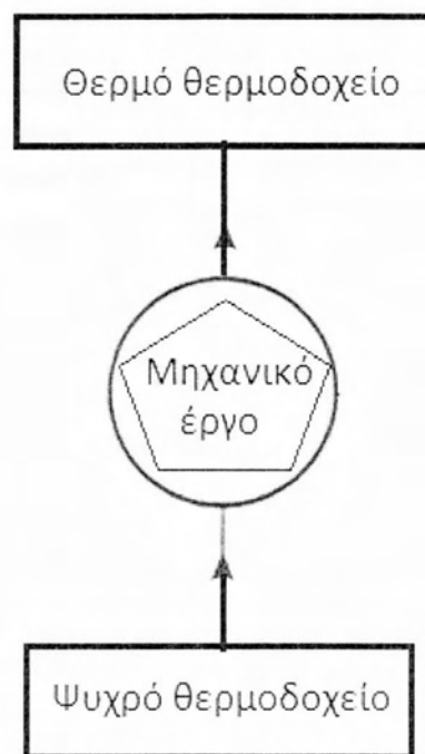
Σχήμα 3.3 Φορά μεταφοράς θερμότητας στην αντλία θερμότητας
