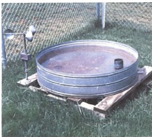
Εξατμισόμετρο (αριστερά) και λυσίμετρο (δεξιά)
