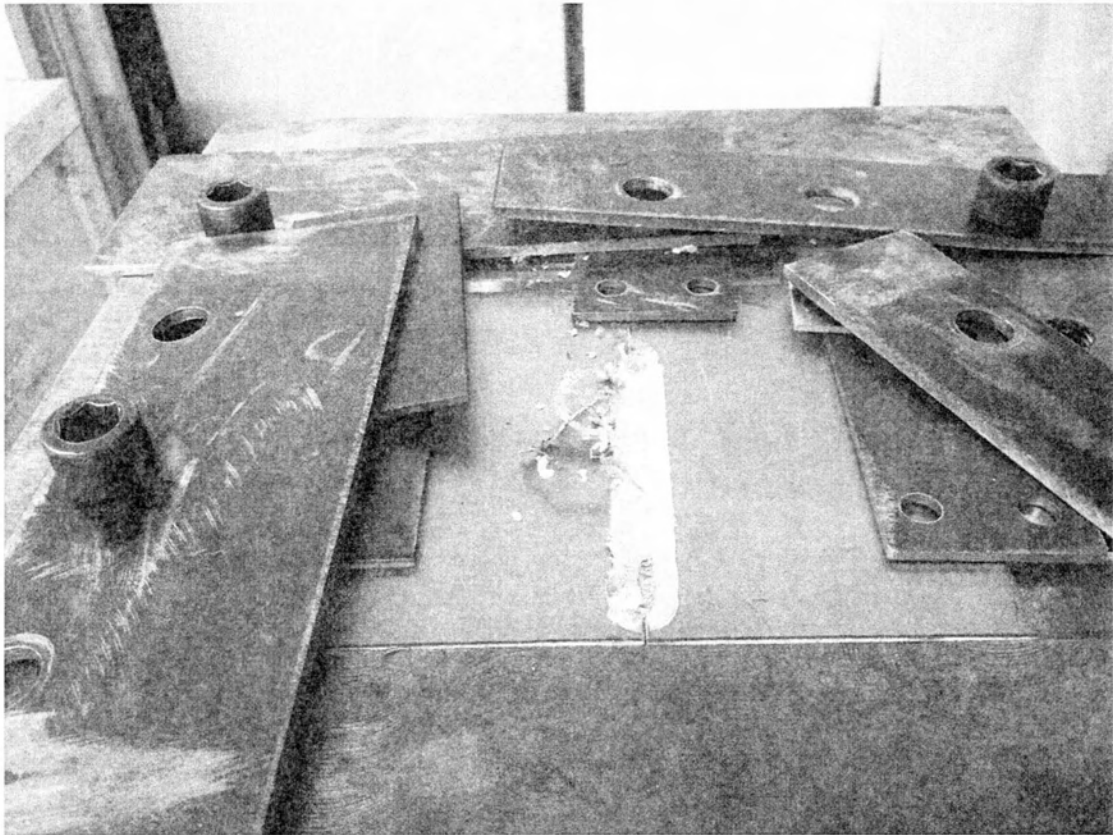
Εικόνα 73: Συγκόλληση ελασμάτων AZ31 παράλληλα στη διεύθυνση ελάσεώς τους
