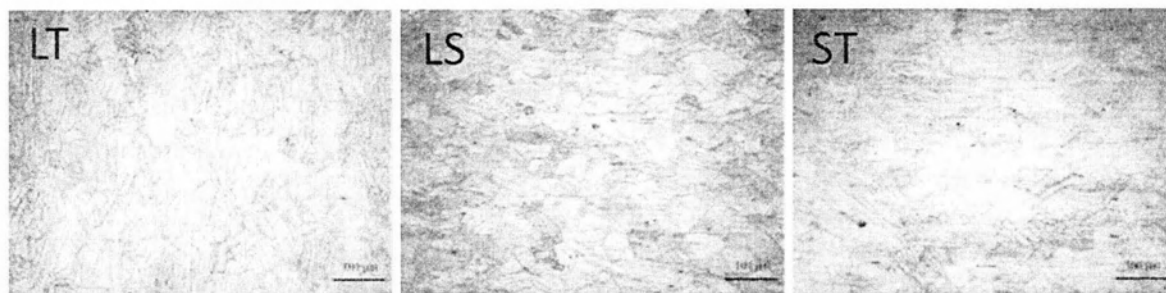
Εικόνα 20: Μικροδομή ελάσματος WE43-T5 στις τρεις (3) διευθύνσεις. Μέγεθος κόκκου με μεγάλη διασπορά τιμών 20-80μm. Μέσο μέγεθος 60μm [6]
