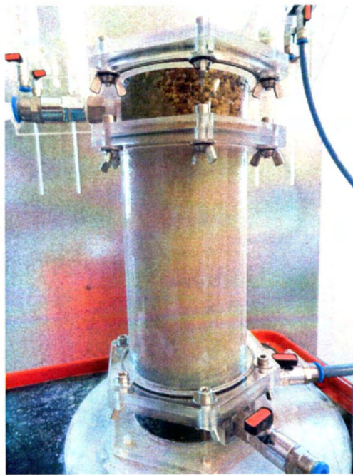
Σχήμα 4.23. Είσοδος του σταθεροποιητή στην άμμο (δοκιμή 4).
