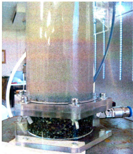
Σχήμα 4.5. Μετατόπιση μετώπου CS και είσοδός του στο αμμόδες υλικό.
