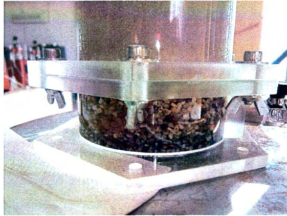
Σχήμα 4.4. Εμφάνιση CS στο χονδρόκοκκο υλικό (δοκιμή 1).
