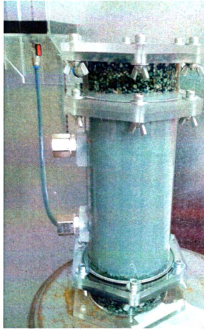
Σχήμα 4.8. Πλήρης χρωματισμός δοκιμίου μετά από κατακλυσμό του δοκιμίου με πυριτία (δοκιμή 1).
