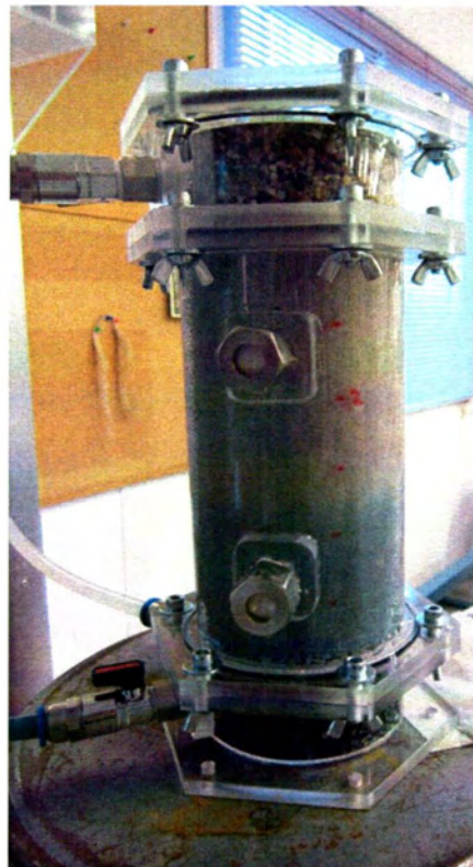
Σχήμα 4.7. Μετατόπιση μετώπου CS εντός του δοκιμίου πάνω από την πρώτη δειγματοληψία (δοκιμή 1).
