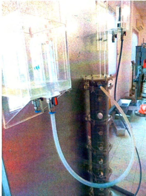
Σχήμα 4.49. Πλήρης χρωματισμός δοκιμίου και εμφάνιση CS στη δεξαμενή εξόδου (δοκιμή 1m) κατά τη διάρκεια της δοκιμής 8.
