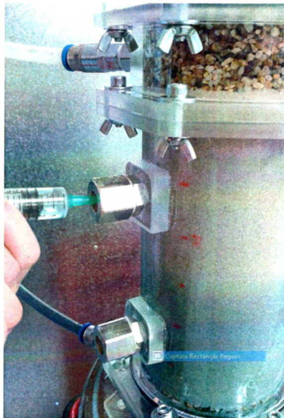
Σχήμα 3.16. Θέση μετώπου κολλοειδούς πυριτίας (με μπλε χρώμα) στο μέσο ύψος εντός μικρού δοκίμιου άμμου. Φαίνεται η σκούρα μπλε είσοδος της πυριτίας στο σωλήνα στο
