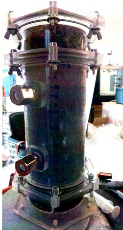
Σχήμα 4.17. Θέση του μετώπου CS λίγο μετά (πάνω από) τη δεύτερη δειγματοληψία στη δοκιμή 3.
