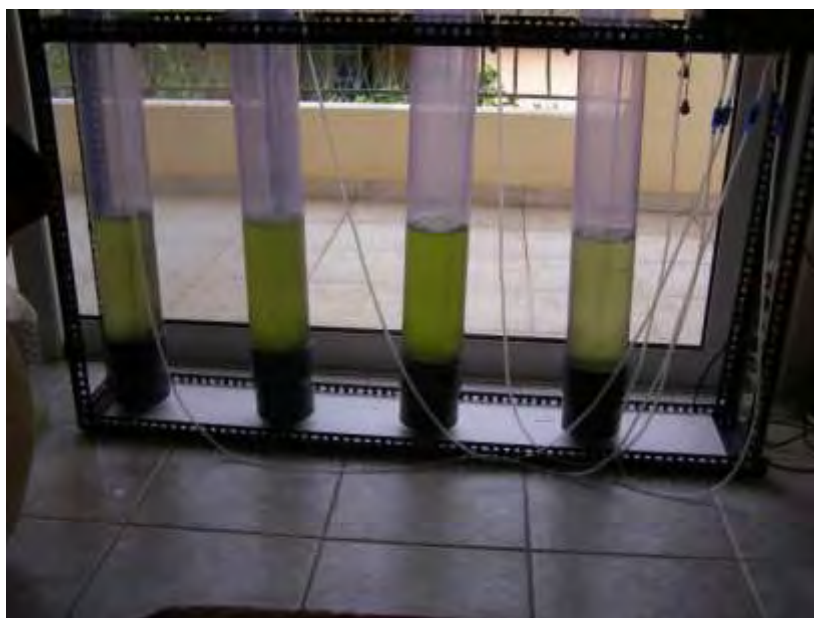
Εικόνα 31. Καλλιέργεια σε φωτοβιοαντιδραστήρες. Στους δύο από αριστερά (PBR 1 & 2) το χλωροφύκος αναπτύσσεται σε θρεπτικό μέσο BBM-3N, ενώ στους δύο επόμενους (PBR 3 & 4) σε θρεπτικό μέσο Nutrileaf.
