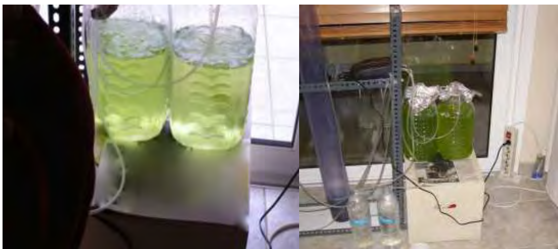
Εικόνα 30. Καλλιέργεια σε πλαστικά διάφανα δοχεία 5 L. Ο τελικός όγκος της καλλιέργειας σε κάθε δοχείο έφθασε στα 4 L.
