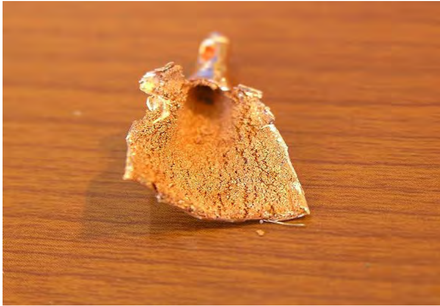
Σχήμα 3.1: Δομή του φυτιλιού
