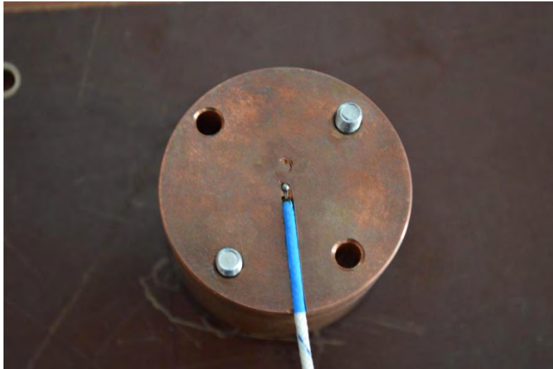
Σχήμα 4.3: Το θερμοστοιχείο στον πυρήνα από χαλκό
