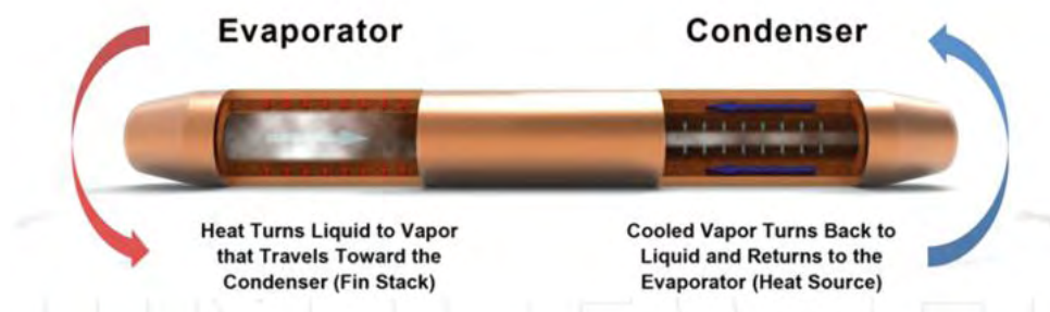
Σχήμα 2.9: Cylindrical heat pipe
