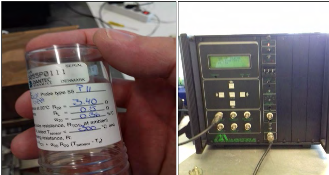
Σχήμα 4.2: Ο αισθητήρας διαμέτρου 5 \mu\text{m} και ο ενισχυτής του θερμο-ανεμόμετρου
