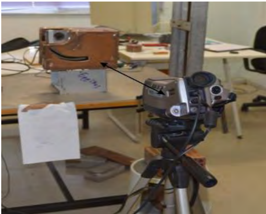
Σχήμα 4.5: Τοποθέτηση της κάμερας σε απόσταση 1,5m από τη συσκευή
