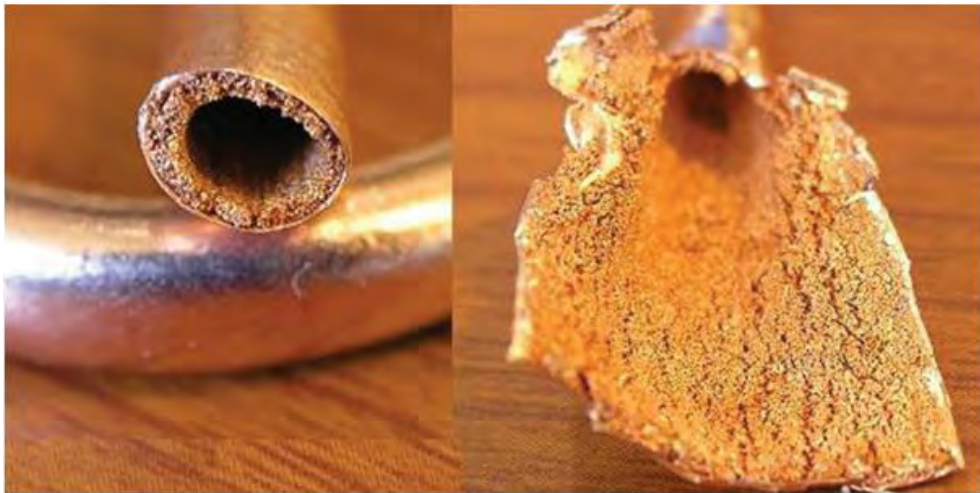
Σχήμα 2.5: Metal sintered powder wick
