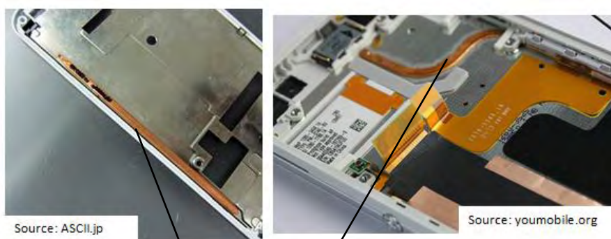
Σχήμα 1.7: heat pipe σε ένα κινητό τηλέφωνο
