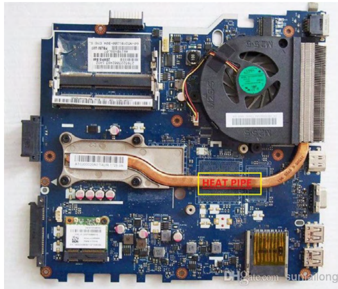
Σχήμα 1.1: Motherboard με εμφανές το heat pipe
