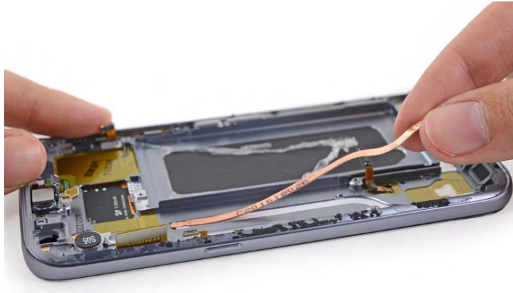
Σχήμα 1.8: heat pipe σε τελευταίας γενιάς smartphone τύπου Samsung Galaxy 8
