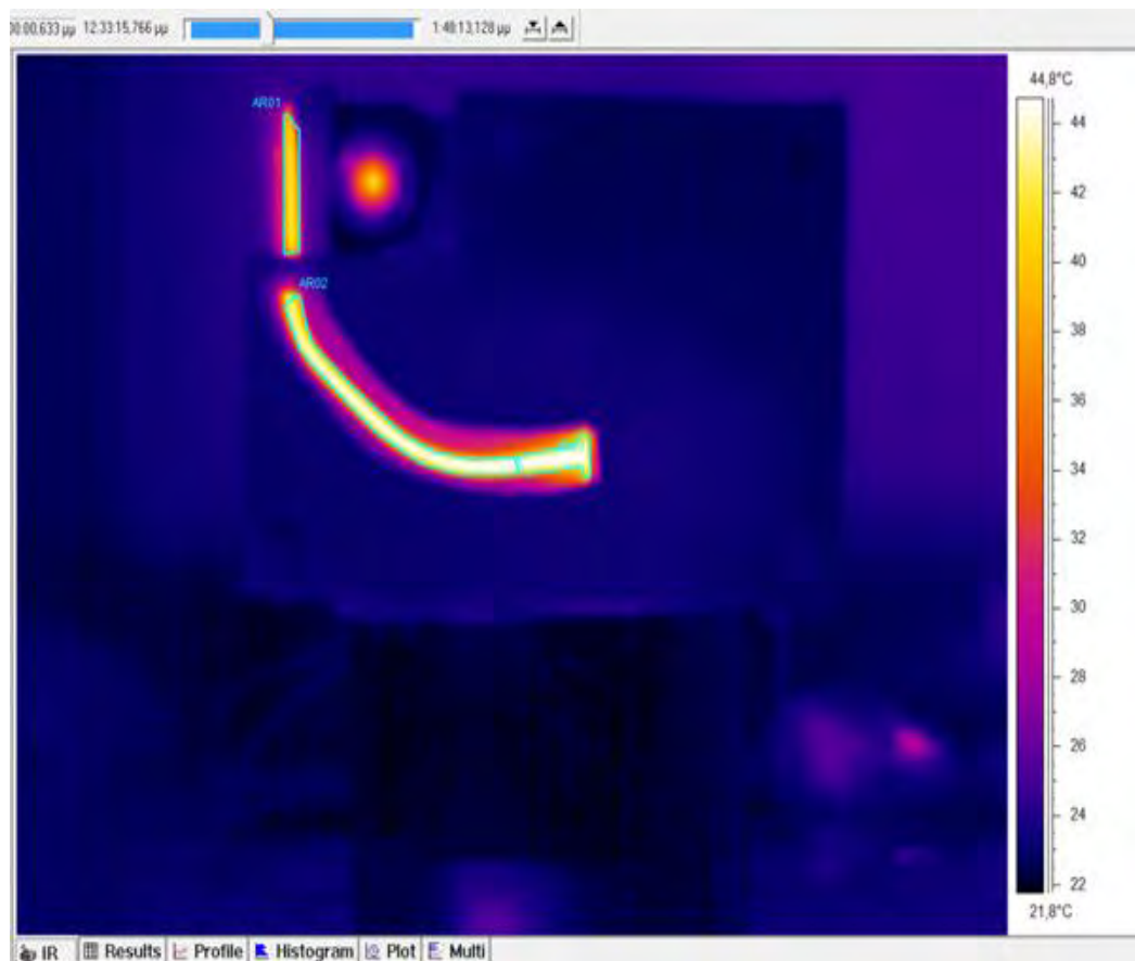
Σχήμα 5.37: Η ανάλυση με βάση τις τρεις περιοχές του heat pipe
