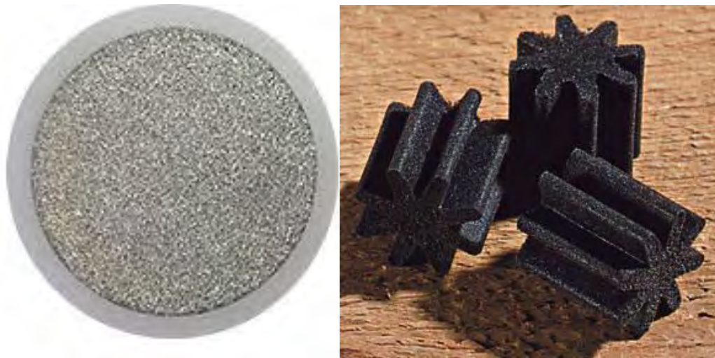
Εικόνα 1: Πορώδη φίλτρα, αριστερά φίλτρο διαλύτης, δεξιά πολυμερές φίλτρο. 12
