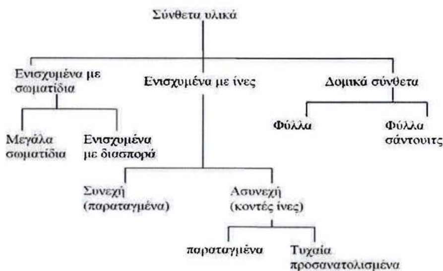
Σχ. 6 - Ταξινόμηση των διαφόρων τύπων σύνθετων υλικών
