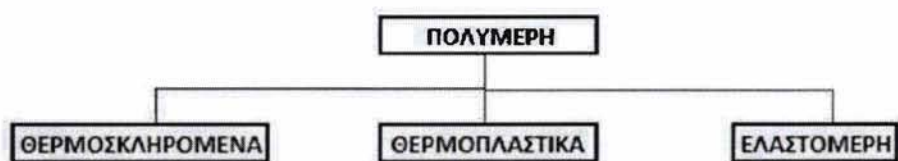
Σχ. 3 - Κατάταξη πολυμερών βάσει των μηχανικών τους ιδιοτήτων σε υψηλές θερμοκρασίες
