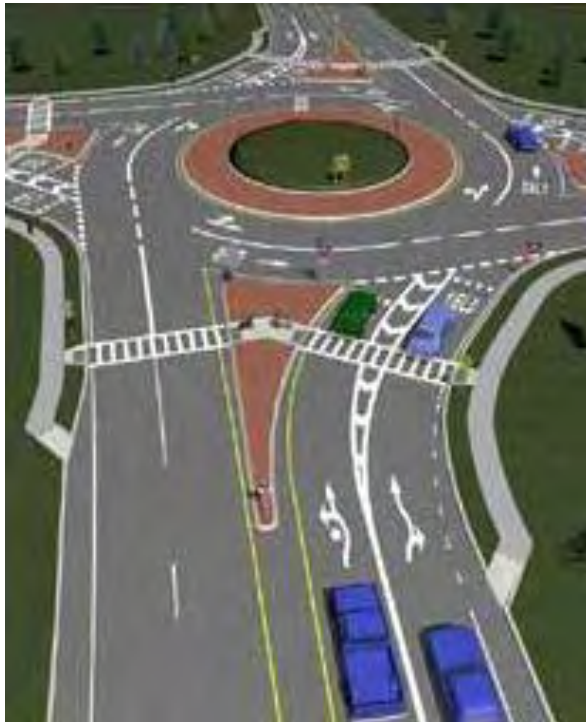
Εικόνα 2.4-1 :Παράδειγμα διαμόρφωσης εισόδου για διέλευση μεγάλων φορτηγών.
