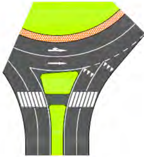
Σχήμα 4.3-4: Πεζοδιαβάσεις ευθυγραμμισμένες κάθετα στον κεντρικό άξονα του κλάδου (μη προτιμώμενη διάταξη).
