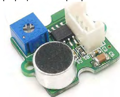
Εικόνα 2-14 : Ένας αισθητήρας μικροφώνου ενσωματωμένος σε πλακέτα (ιδιοκτησία εικόνας Seedstudio)
