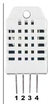
Σχήμα 8-1: Ο αισθητήρας DHT22 θερμοκρασίας και υγρασίας. Pin 1: Τροφοδοσία 5V. Pin2: Έξοδος δεδομένων. Pin3: Δεν χρησιμοποιείται. Pin 4: GND
