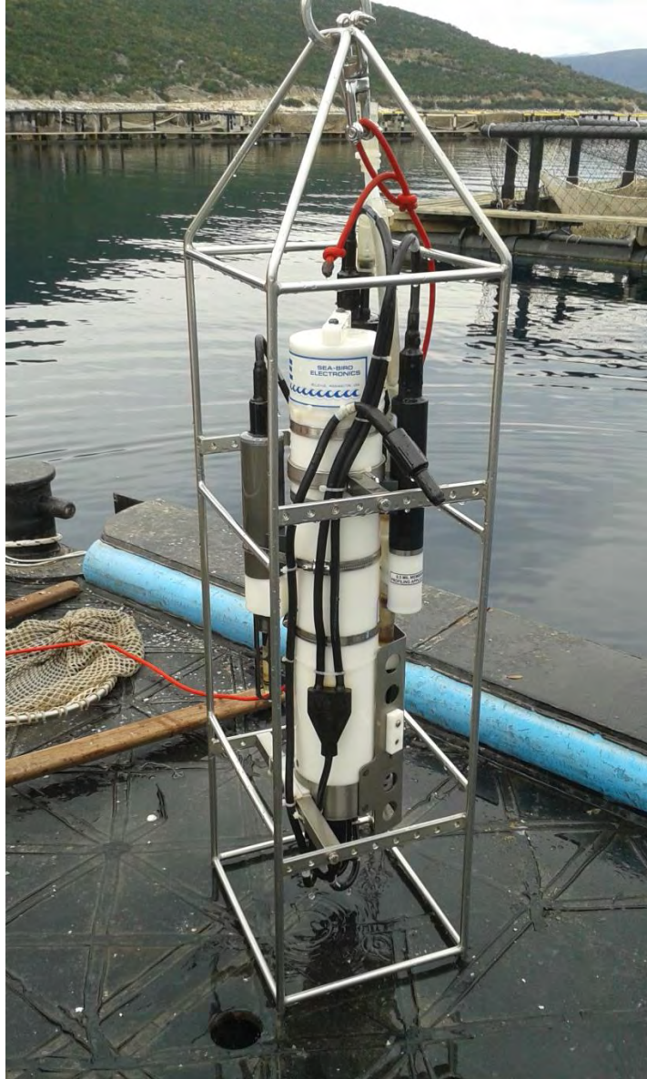
Εικόνα 2.3: Συνεχής καταγραφέας φυσικοχημικών χαρακτηριστικών του νερού (SEABIRD-19plus).
