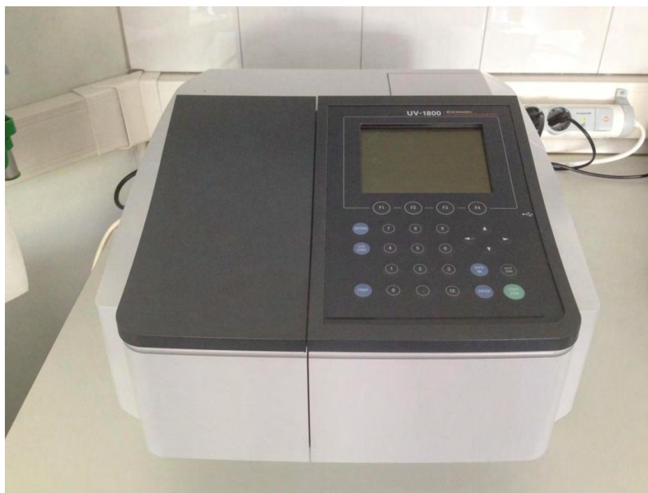
Εικόνα 2.4: Φασματοφωτόμετρο για τις αναλύσεις των θρεπτικών αλάτων του νερού (SHIMADZU UV-1800).
