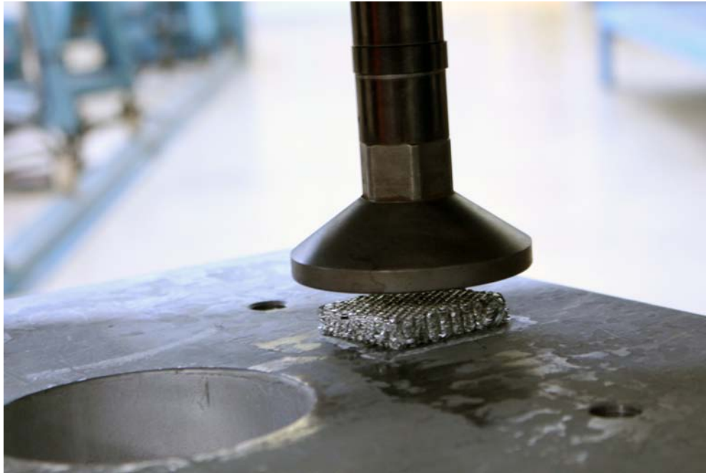
Εικόνα 3-5 Δοκίμιο μετά την κρούση
