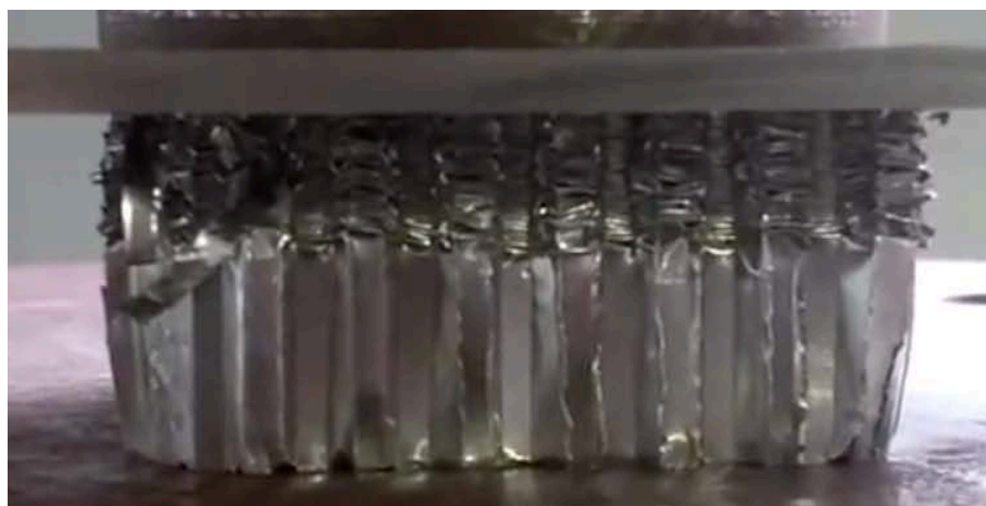
Εικόνα 5-1 Δοκίμιο κυψέλης αλουμινίου κατά τη θλίψη
