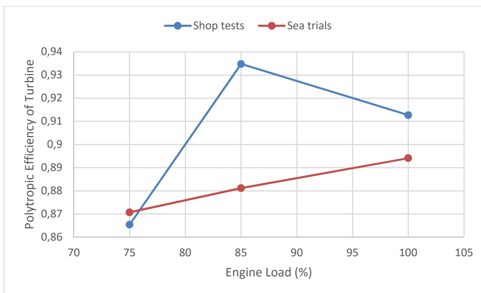
Σχήμα 4.23 : Πολυτροπικός β.α. στροβίλου για shop tests και sea trials
