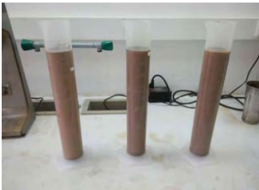
Εικόνα 3. Μέτρηση κοκκομετρικής σύστασης.
