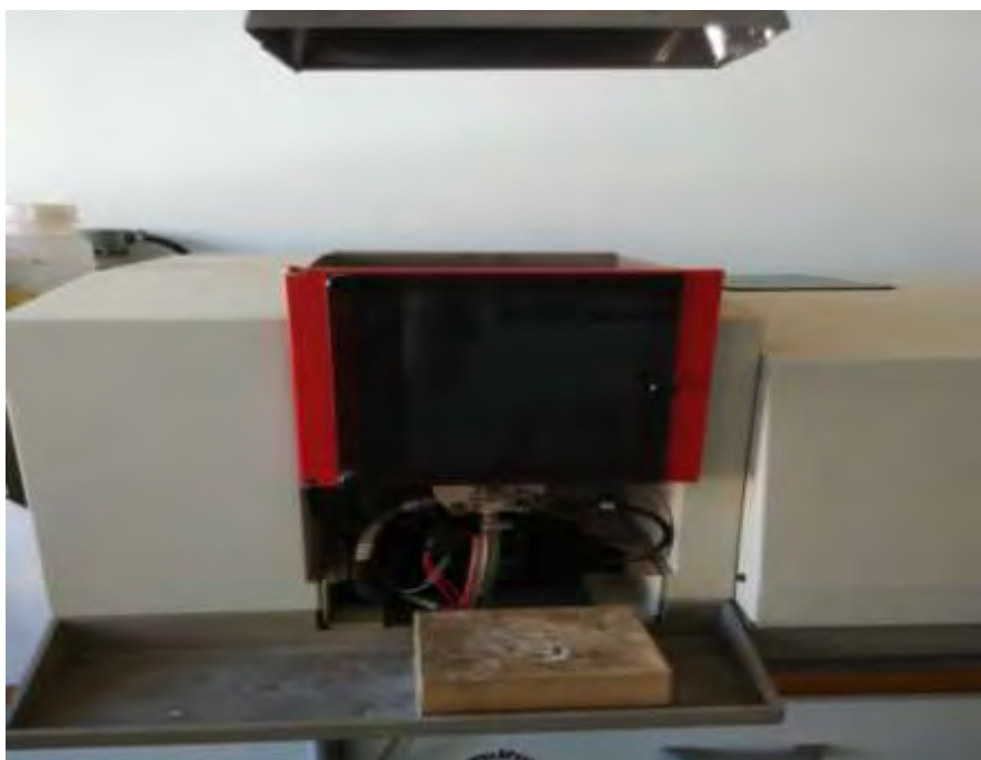
Εικόνα 4. Συσκευή ατομικής απορρόφησης.
