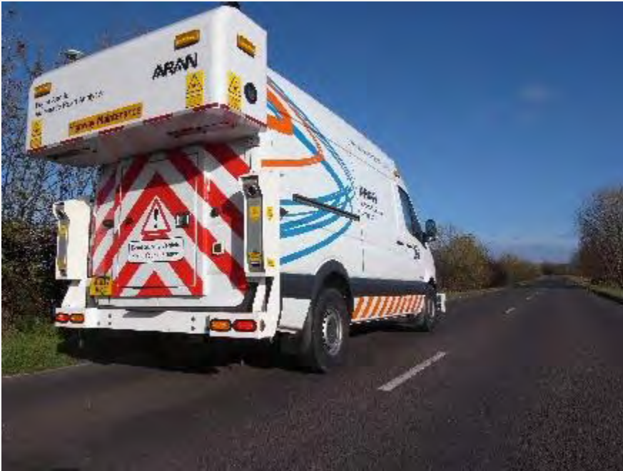
Σχήμα 2.6. Όχημα την ώρα που σκανάρει την οδό
