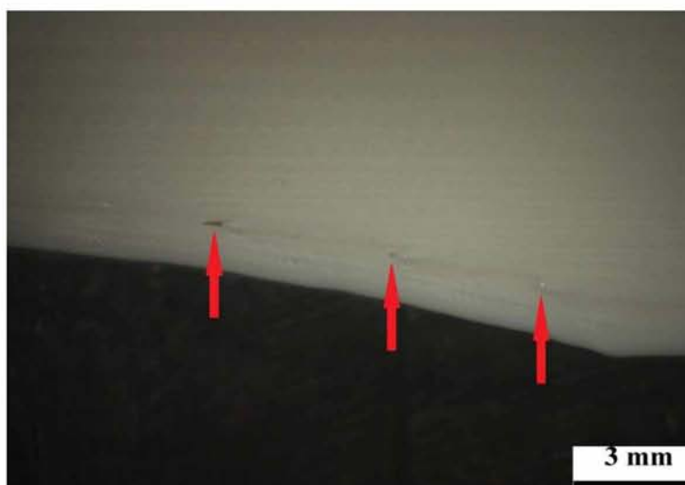
Εικόνα 3.2.1: Σημεία συγκέντρωσης τάσεων στη ραδίωση.
