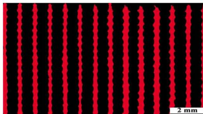
Εικόνα 4.2.11: Επιφάνεια κενών (κόκκινο χρώμα) στην πλήρωση.
