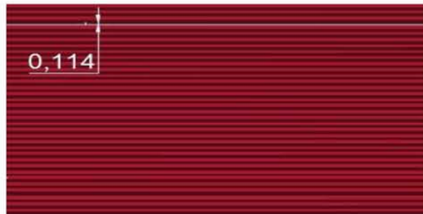
Εικόνα 3.2.3: Κενό μεταξύ πλήρωσης και περιμέτρου στην προεπισκόπηση της εκτύπωσης.
