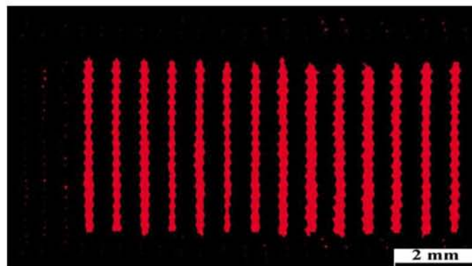
Εικόνα 4.2.10: Επιφάνεια κενών (κόκκινο χρώμα) στο μισό τμήμα της επιφάνειας.
