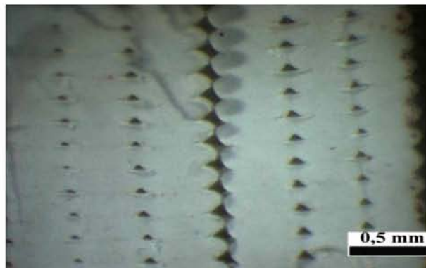
Εικόνα 3.2.7: FDM δομή του νέου δοκιμίου.
