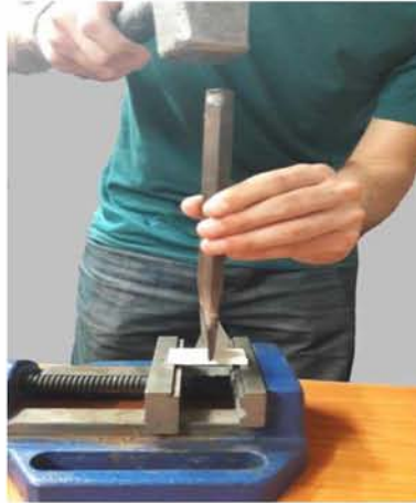
Εικόνα 3.4.2: Σπάσιμο δοκιμίου για μελέτη της δομής.
