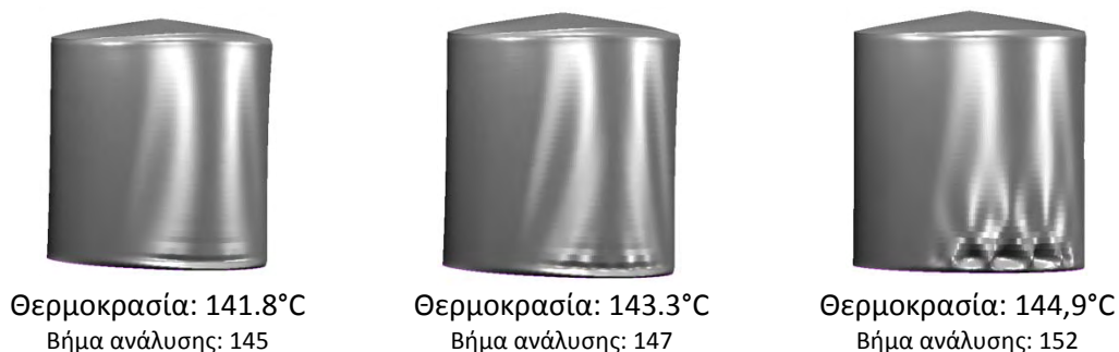
Εικόνα 7. 6 Στιγμιότυπα δεξαμενής 20x20 5 t_c την στιγμή του λυγισμού
