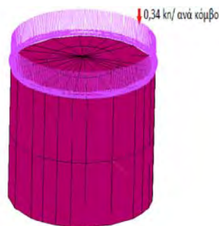
Εικόνα 5. 3 Απεικόνιση της φόρτισης της δεξαμενής 20x20 λόγω ιδίου βάρους της οροφής
