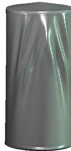
Εικόνα 8.4 66 Δεξαμενή 40x20 , tr=10tc με μεταβαλλόμενο πάχος κελύφους περίπτωσης β , στο στάδιο λυγισμού(139° C).
