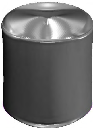
Εικόνα 7. 7 Παραμορφώσεις οροφής σε δεξαμενή 20x20 , 1t_c (πριν το λυγισμό της κυλινδρικής επιφάνειας)
