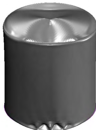
Εικόνα 7. 9 Δεξαμενή 20x20 , 1t_c την στιγμή που παθαίνει λυγισμό η κυλινδρική επιφάνεια του κελύφους (σε θερμοκρασία 165°C, με μέγιστες παραμορφώσεις οροφής = 5cm)
