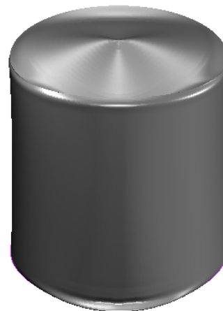
Εικόνα 7. 8 Παραμορφώσεις οροφής σε δεξαμενή 20x20 , 2t_c (πριν το λυγισμό της κυλινδρικής επιφάνειας)
