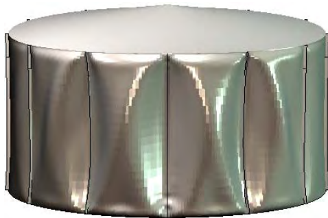
Εικόνα 8.3. 3 Δεξαμενή 10x20, t_r=10t_c με κατακόρυφους δακτυλίου ανά 30°, στο στάδιο λυγισμού (190° C).
