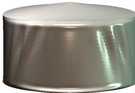
Εικόνα 8.3. 3 Δεξαμενή 10x20, t_r=10t_c με κατακόρυφους δακτυλίου ανά 30°, στο στάδιο λυγισμού (190° C).
