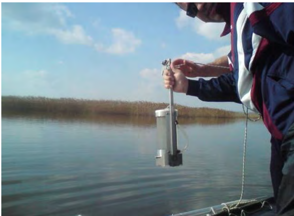
Εικόνα 2.2: Δειγματολήπτης νερού (Limnos Rossincatu 2 E 17 20380 Turku Finland)
