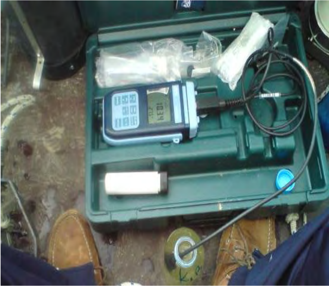
Εικόνα 2.3: Ειδικό φορητό όργανο μέτρησης pH και DO (Consort C 531).
