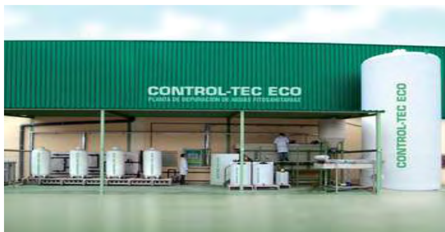
Εικόνα 3. Το σύστημα CONTROL-TECECO® το οποίο διατίθεται για την επεξεργασία υγρών αποβλήτων που παράγονται από συσκευαστήρια φρούτων και περιέχουν TBZ. Πηγή: tecnidex.es
