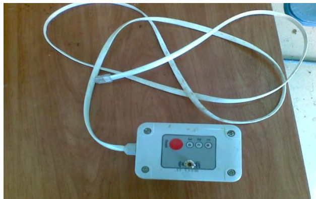
Εικόνα 3.6. Ειδικό όργανο για το καλιμπράρισμα του αισθητήρα μέτρησης διαμέτρου βλαστού.
