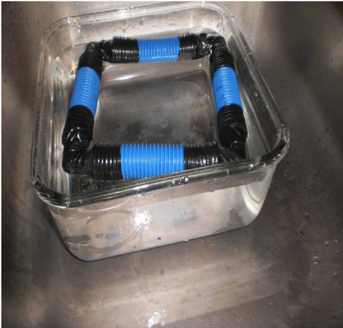
Εικόνα 10: Η δοκιμή πλευστότητας του άνω τμήματος των ιχθυοκλωβών.
