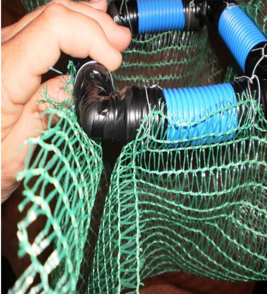
Εικόνα 11: Η ένωση του δικτυού με τους πλωτήρες.
