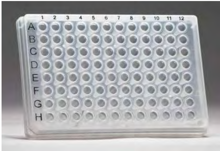
Εικόνα 12. Τρυβλίο 96 θέσεων (96 well plate)
