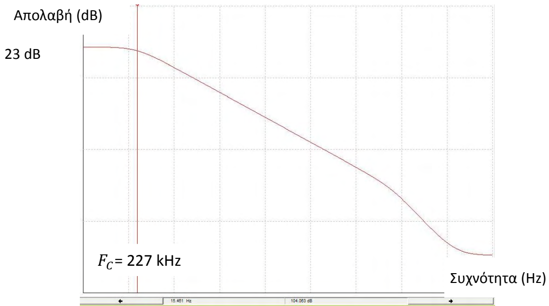
Διάγραμμα 2: Διάγραμμα Bode του πρώτου τελεστικού ενισχυτή TL072
