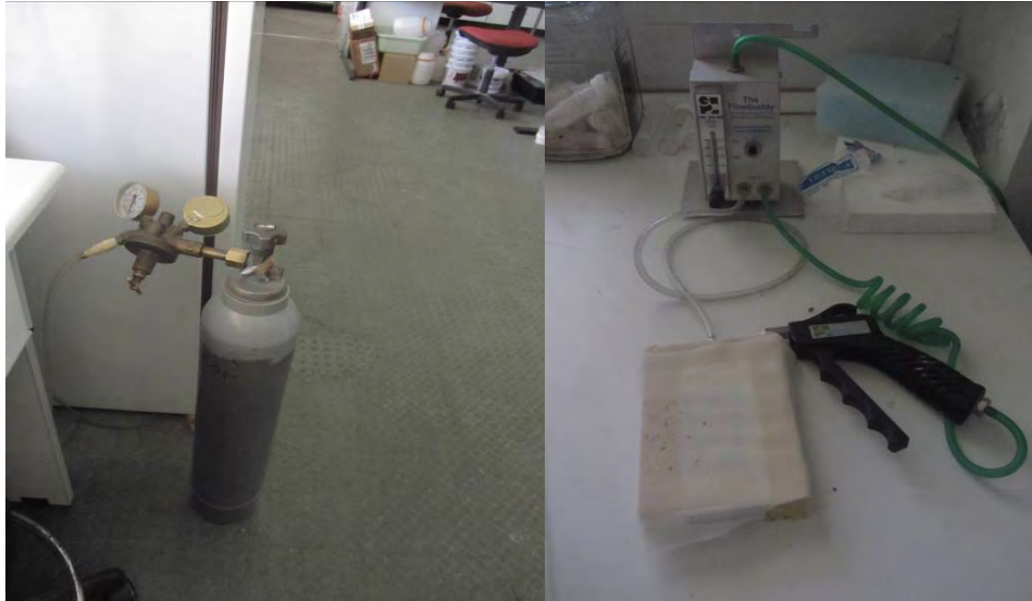
Εικόνα 2.8 Σύστημα αναισθητοποίησης ενηλίκων της μύγας της Μεσογείου με CO 2 .
