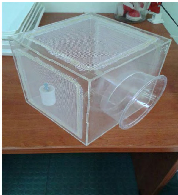
Εικόνα 2.3 Κλουβί από Plexiglass για τη διατήρηση των ενηλίκων.
