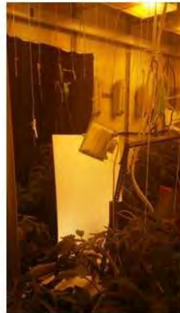
Εικόνα 18. Απεικόνιση του εσωτερικού του θαλάμου ανάπτυξης φυτών σε προσπάθεια καταγραφής λευκού στόχου με τη χρήση της υπερφασματικής κάμερας.
