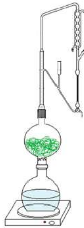
Εικόνα 2. 4: Απόσταξη με ατμό με αποστακτική διάταξη τύπου Clevenger
