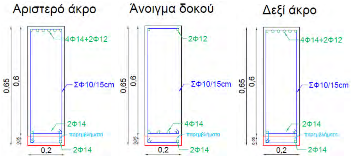
Σχήμα 5-59: Διατομές ενισχυμένης δοκού Δ14.2-Δ14.3 στη στάθμη 2
