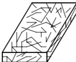
Σχήμα 3-18: Σύνθετο υλικό κατηγορίας ασυνεχών ινών (Σπυράκος, 2004)
