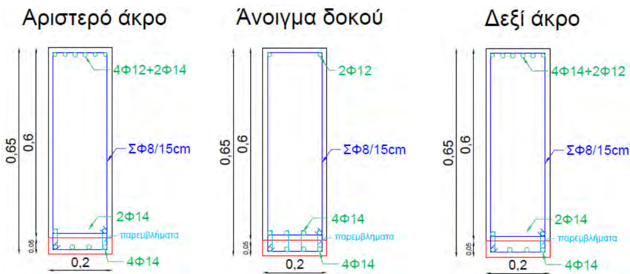
Σχήμα 5-21: Διατομές ενισχυμένης δοκού Δ14.1 στη στάθμη 2
