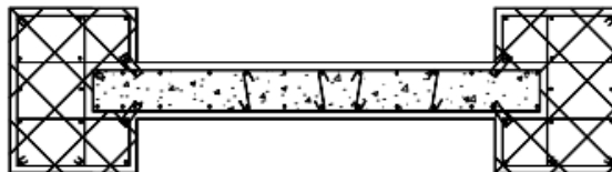
Σχήμα 3-9: Καμπτική ενίσχυση τοιχώματος (Σπυράκος, 2004)
