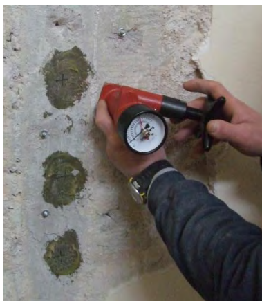
Σχήμα 2-6: Δοκιμή εξόλκευσης ήλου (Σιδέρης, Δομικοί Έλεγχοι)
