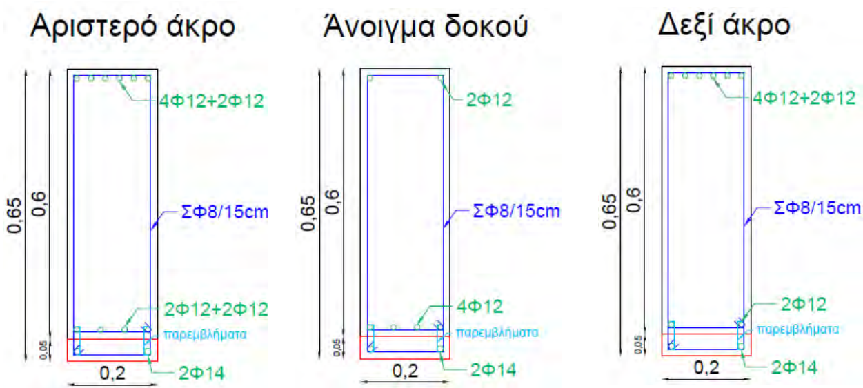
Σχήμα 5-61: Διατομές ενισχυμένης δοκού Δ2.3 στη στάθμη 3
