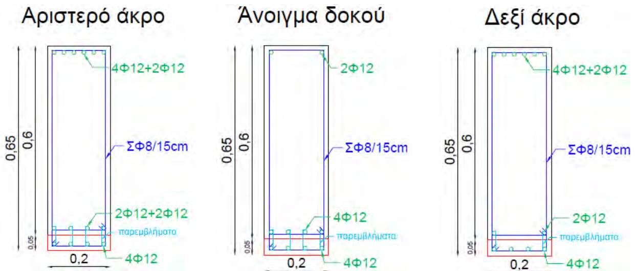
Σχήμα 5-13: Διατομές ενισχυμένης δοκού Δ2.3 στη στάθμη 1
