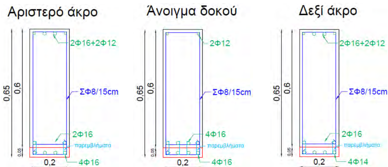
Σχήμα 5-20: Διατομές ενισχυμένης δοκού Δ10.1-Δ10.2 στη στάθμη 2
