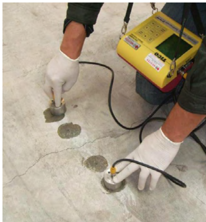
Σχήμα 2-2: Μέθοδος υπερήχων (Σιδέρης., Δομικοί Έλεγχοι)
