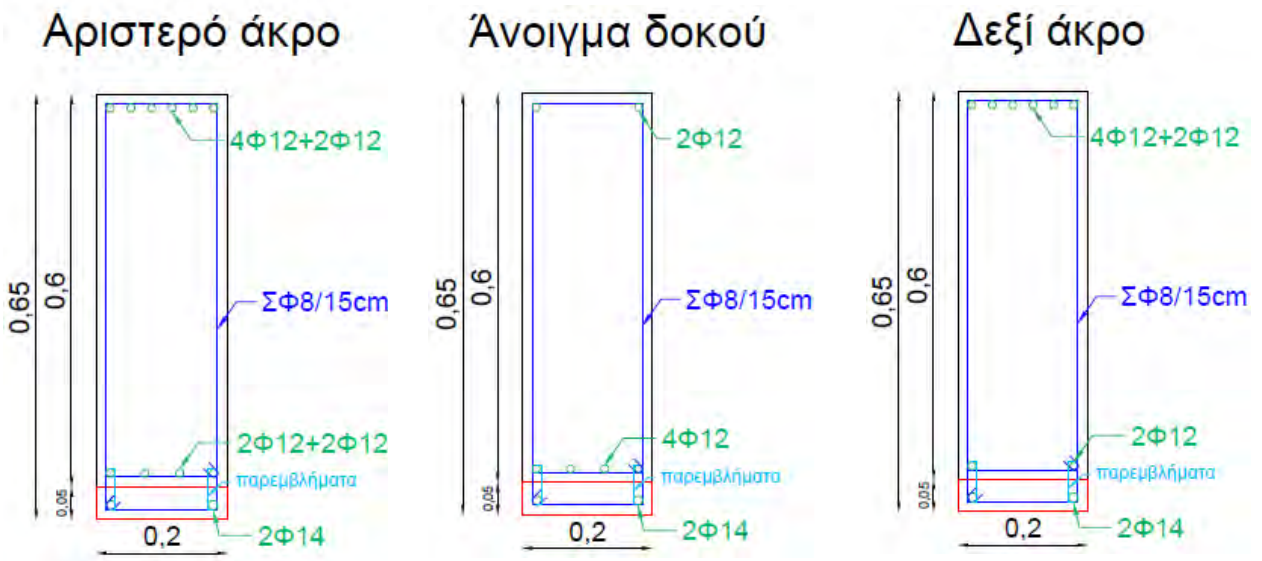
Σχήμα 5-55: Διατομές ενισχυμένης δοκού Δ2.3 στη στάθμη 2
