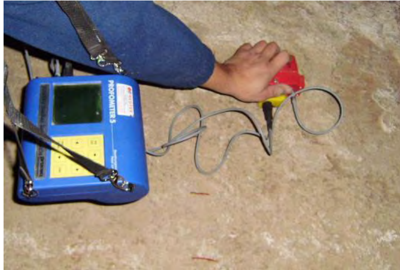
Σχήμα 2-3: Ανίχνευση οπλισμού με τη μαγνητική μέθοδο (Σιδέρης, Δομικοί Έλεγχοι)
