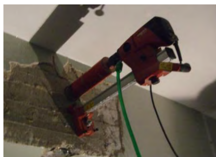
Σχήμα 2-5: Λήψη πυρήνα από δοκό (Σιδέρης, Δομικοί Έλεγχοι)
