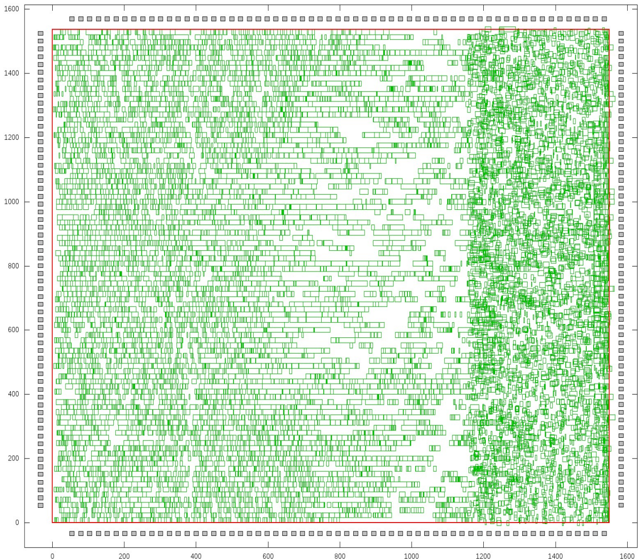
Εικόνα 5.1.4 : Αποτύπωση στα \frac{3}{4} του πλήθους των κελιών του ibm01
