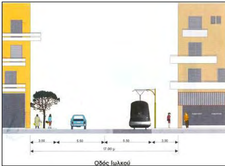
Εικόνα 8.1: Σχέδιο κατασκευής της υποδομής Τραμ
